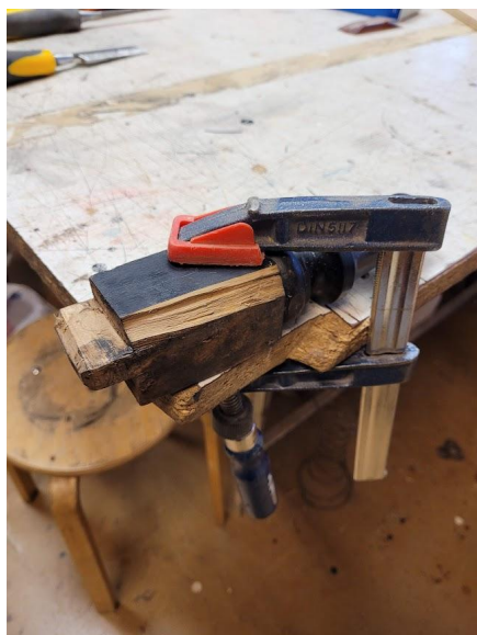
Pilt 6 ja 7 Parandustüki paigaldamine
