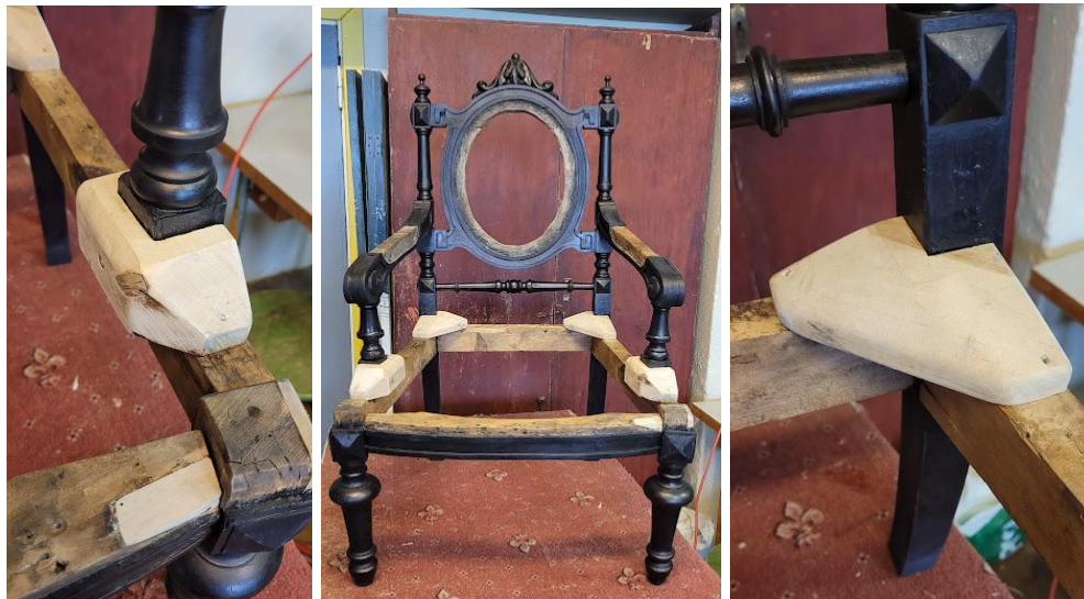
Pilt 17,18, 19. Polstriklotside paigaldamine
