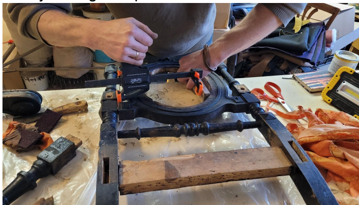
Pilt 5 Seljatoe osandamine pitskruviga lahtisurumise asendis
