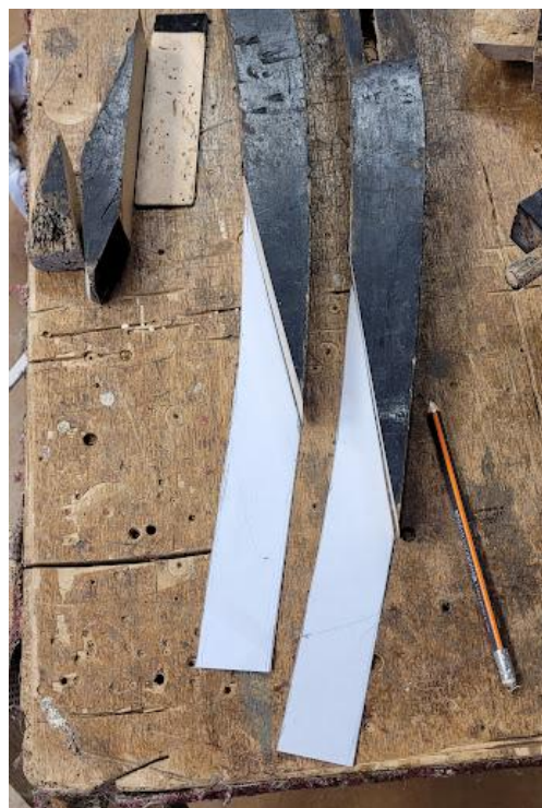
Pilt 12 ja 13 Koitunud toolijalgade asendamine ja žabloonide mõõdistamine
