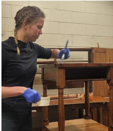
Pilt: Kruvimine (1:1 linaõli, tärpentiin)
