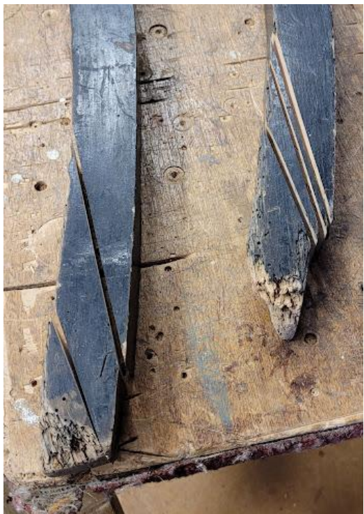
Pilt 12 ja 13 Koitunud toolijalgade asendamine ja žabloonide mõõdistamine
