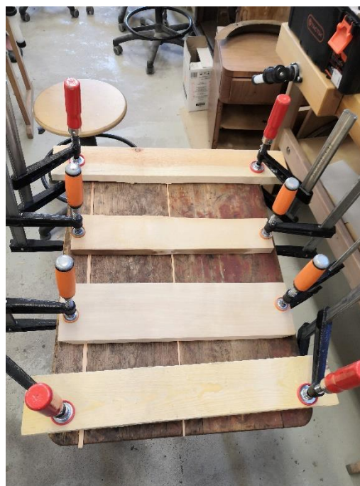
Foto 8. Liimitud ja pressi all liistud lauaplaadil.
