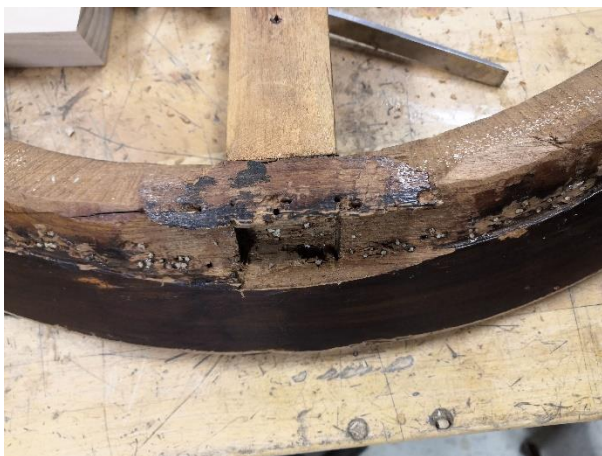
Foto 44. Seljatoeraami ja tugipulga parandamine
