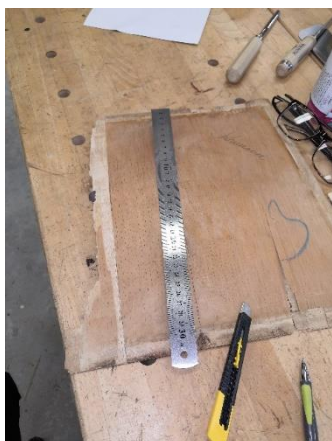
Foto 5. Alumise spoonikihi mõõtmine ja lõikamine
