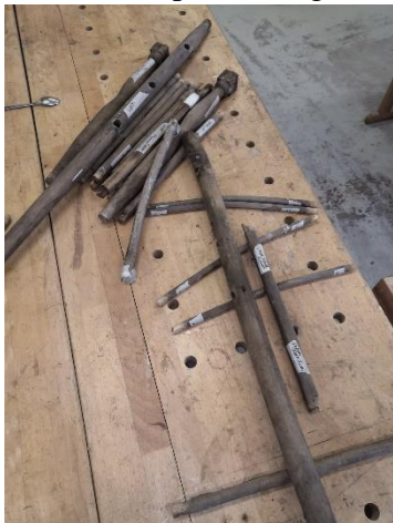
Foto 18. Osandatud tool enne pesu Foto 19. Tooli detailide pesemine
