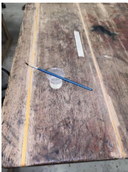
Foto 14. Lauaplaadi liistude vanutamine Foto 15. Lauajala proteeside vanutamine
