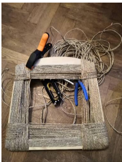
Foto 33. Toolipõhjale nurkade punumine
