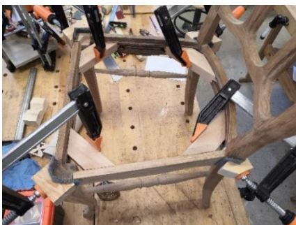
Foto 21. Tugiklotside liimimine tooliraami nurkadesse
