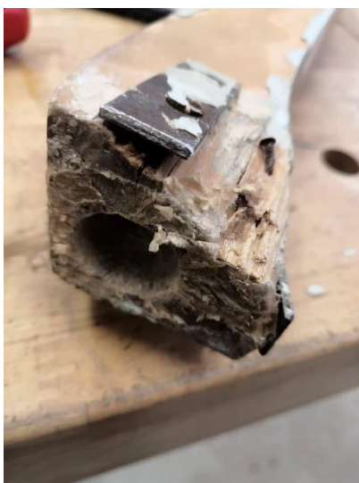
Foto 9. Tapiühendusest lahti murdunud esijalg
