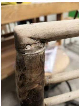
Foto 30. Vahede täitmiseks kasutasin kasespooni. Väiksemad augud täitsin puidupahtliga.
