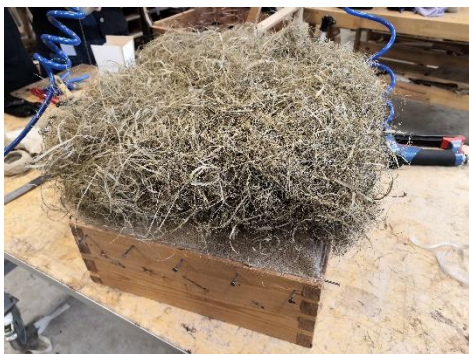
Foto 18. Istmeraamile kinnitatud põhikiht
