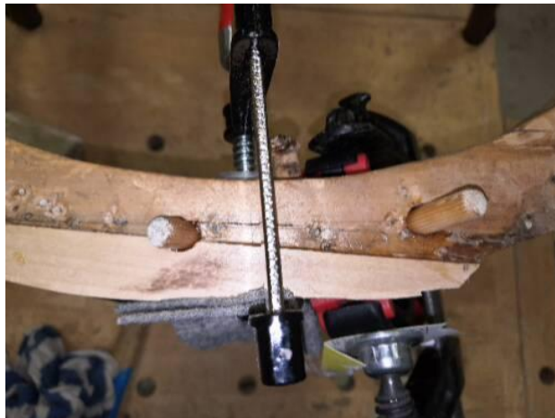
Foto 39. Detaili liimimine ja pressimine pitskruvidega
