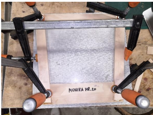
Foto 28. Istmeplaadi raami liimimine
