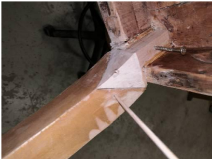
Foto 30. Esijala kinnitamine tooliraamile.
