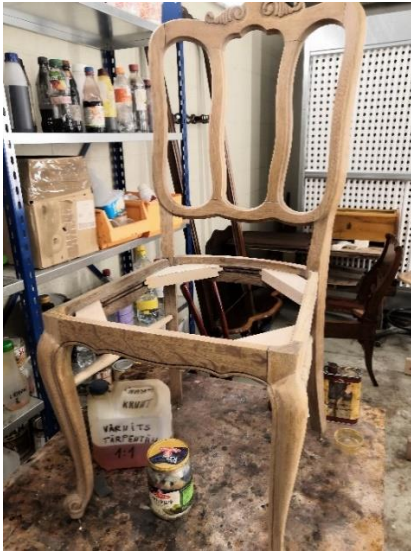
Foto 22. Lõppviimistluseks ettevalmistatud tool.
