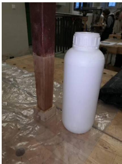
Foto 14. Lauaplaadi liistude vanutamine Foto 15. Lauajala proteeside vanutamine
