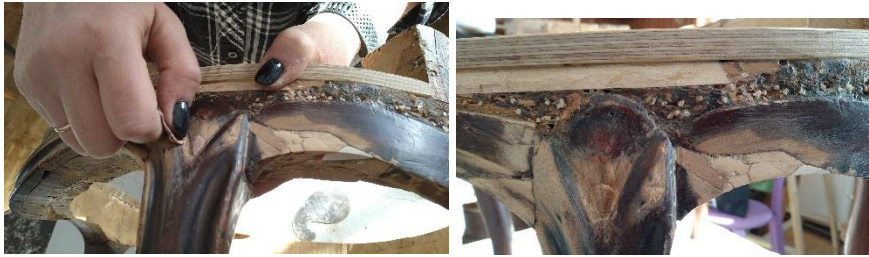
Foto 51. Tooliraami puidulõike lihvimine Foto 52. Lihvitud puidulõige tooliraamil
