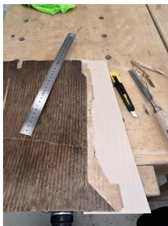
Foto 6. Keskmise ja pealmise spooni mõõtmine
