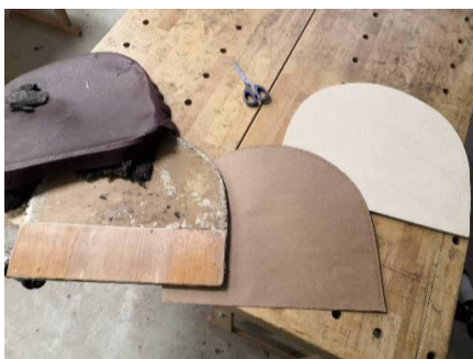
Foto 37. Uue istmeplaadi valmistamine
