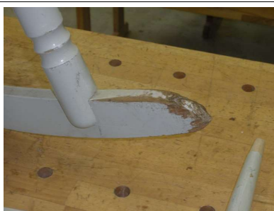
Kiigelaudade esipoolsed otsad kulunud ning puidul killud väljas
