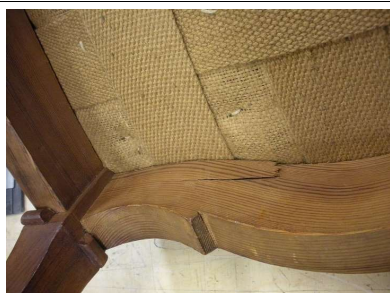
Sarja eespool sisemisel poolel puit lõhestunud
