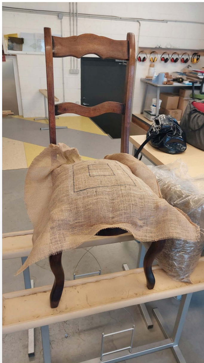
Meriheina paigaldamine täiteasade vahel
