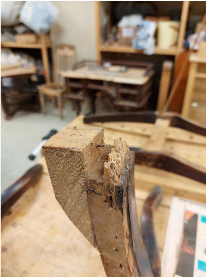
Vana, putukatest söödud ja läbi naelutatud parema sari tapikeel
