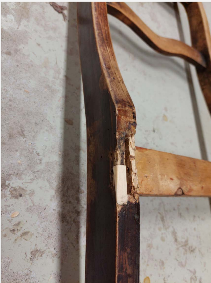
Vana, putukatest söödud ja läbi naelutatud parema sari tapikeel
