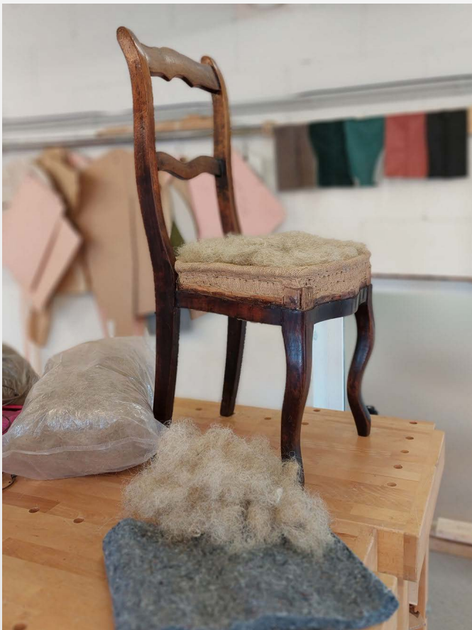
Hobujõhvist polstri ehitamine ja hallist vatiinisegust matiga katmine.
