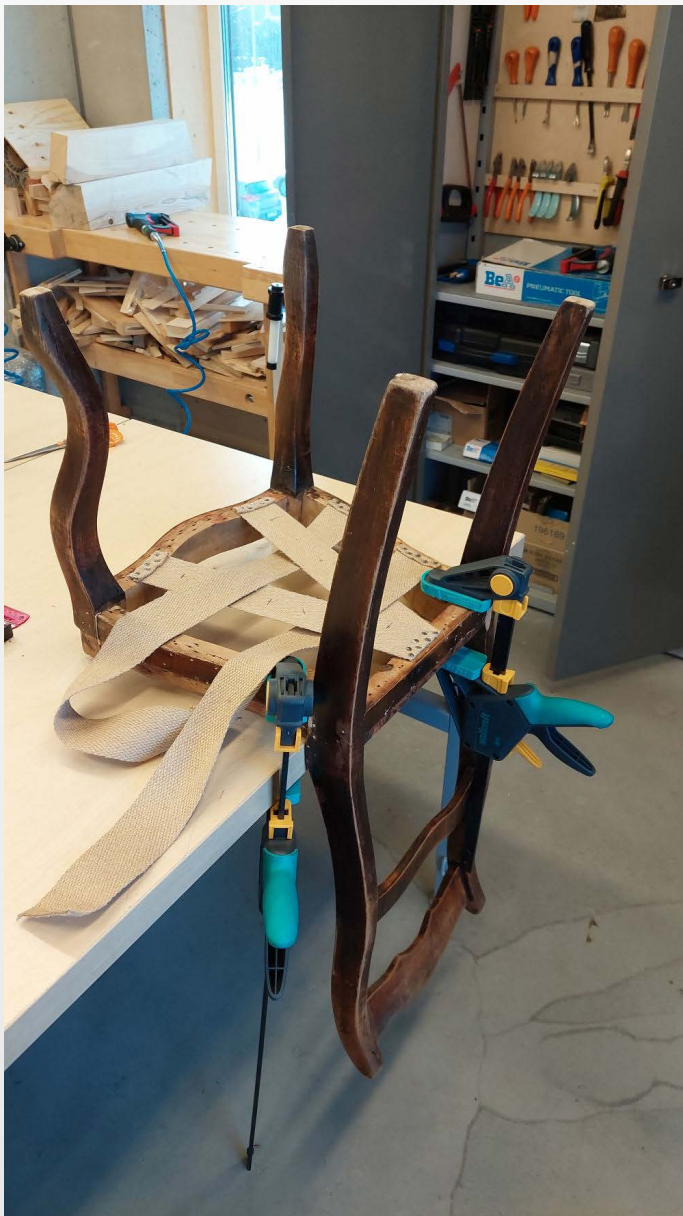
Tooli raami kuju tõttu otsustasime koos juhendajaga algse kahe ristuva rihma asemel kolme rihma, ja v-formatsiooni kasuks
