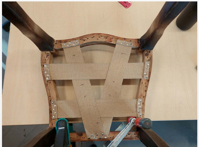
Tooli raami kuju tõttu otsustasime koos juhendajaga algse kahe ristuva rihma asemel kolme rihma, ja v-formatsiooni kasuks
