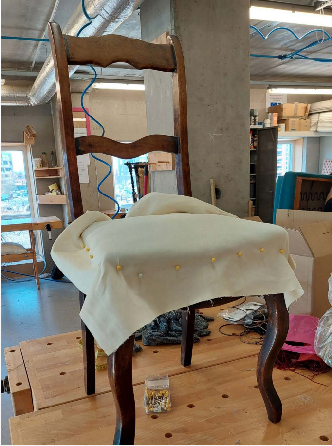
Istmepolstri katmine vaheriide e. mitkaliga.
