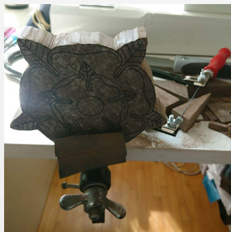
Tooriku fikseerimine laua külge. Jõhvsaga figuursaagimine šablooni järgi.
