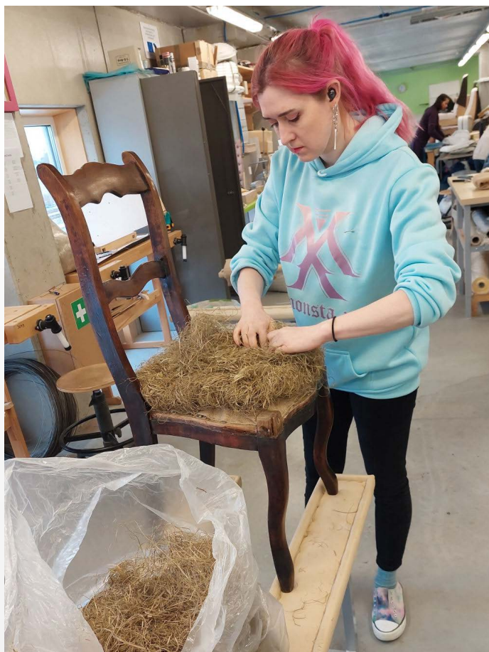
Meriheina paigaldamine täiteasade vahel
