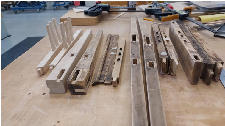
Fotod 23-24. Ülemisel pildil osandatud tool enne restaureerimist. Alumisel pildil kõik tooli lisad, ka parandatud ja juurde tehtud, enne tooli kokku panemist.
