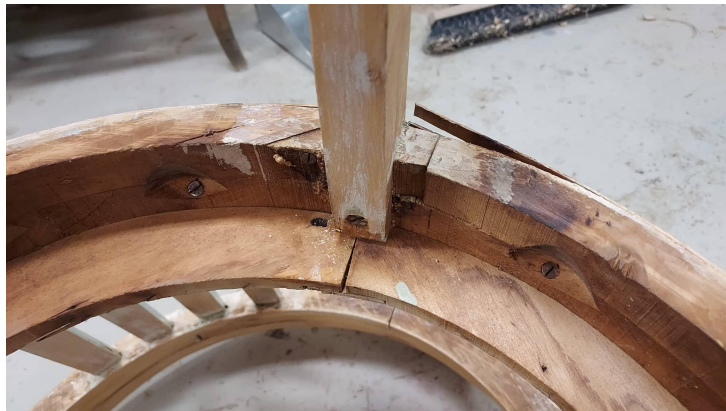
Fotod 4-5. Tooli esijalad on kinnitatud raami külge kruvide ja metallplaatidega. Jalgadel on palju murdumisi. Murdunud tapikeel on kinnitatud raami külge väikeste naeltega.
