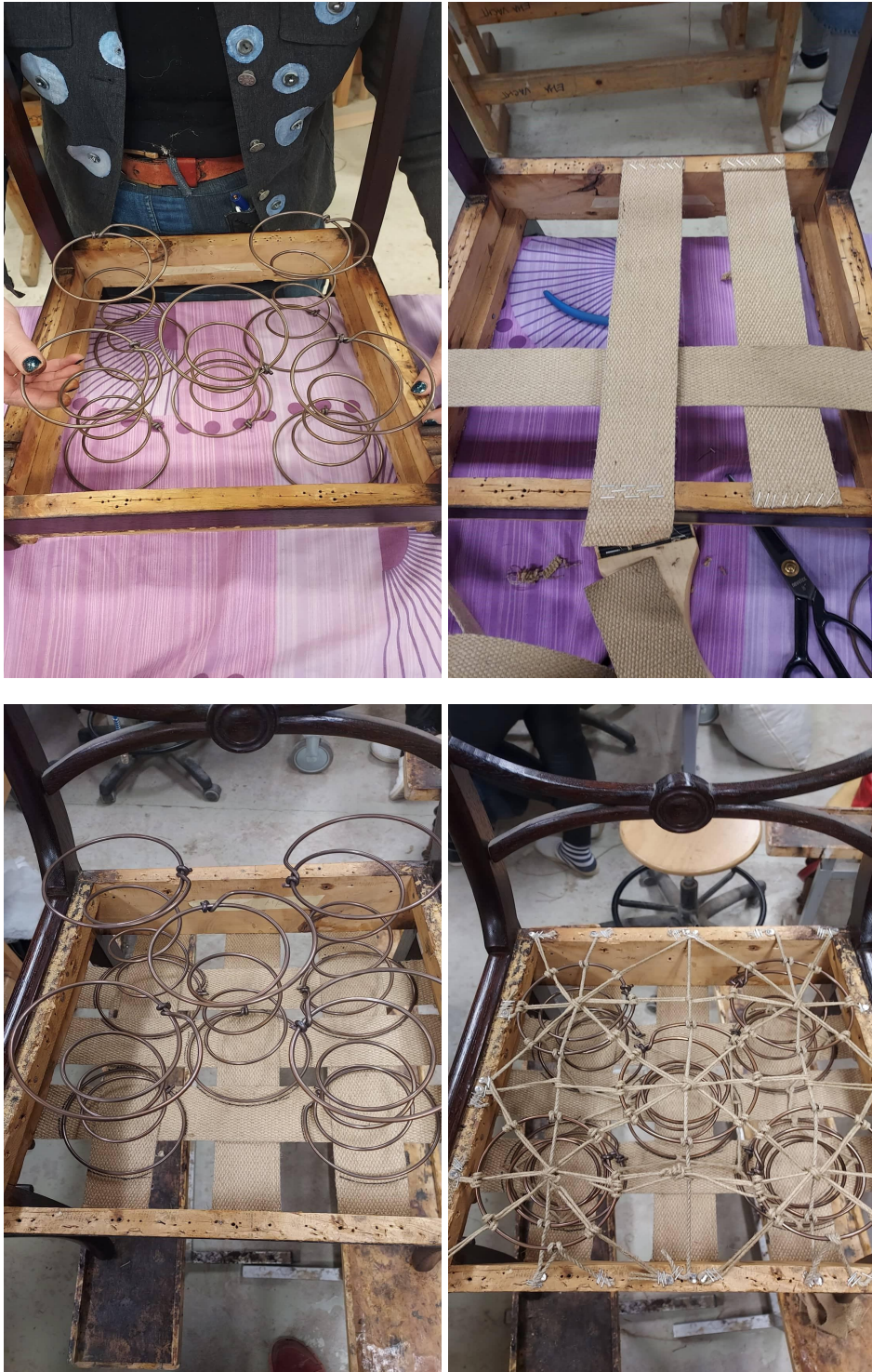
Fotod 19-22. Pehme polstri jaoks sadulavööde ja vedrude kinnitamine.
