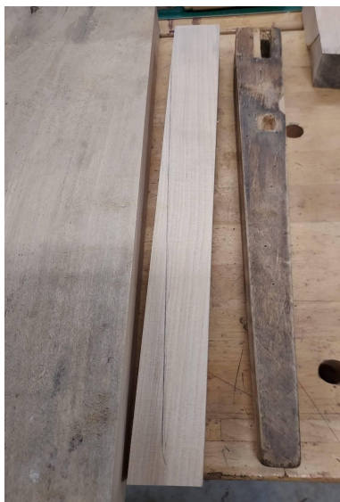
Fotod 5-6. Puuduva vasaku esijala valmistamine.
