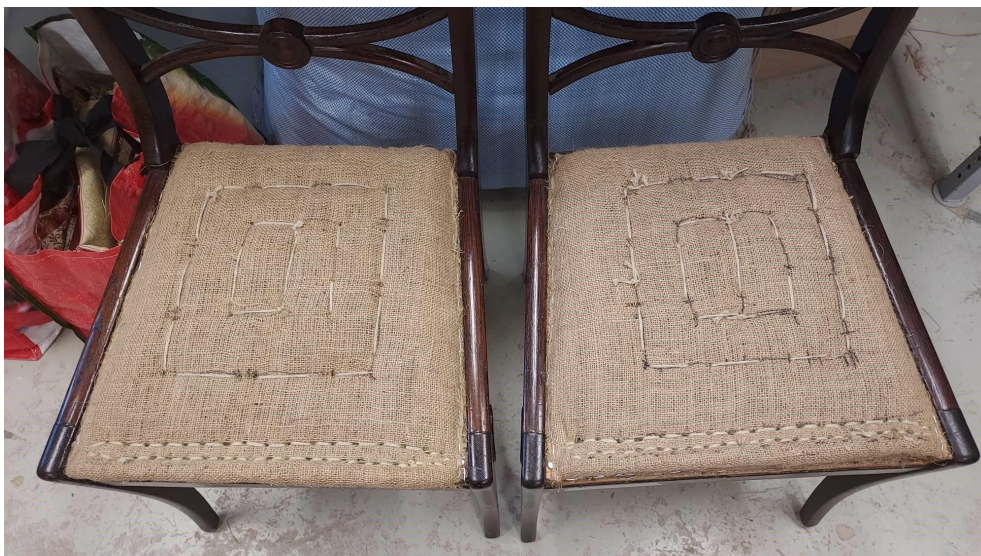
Foto 23. Toolid on kanditud. Algab vatiini ja mitkali pealepanemine.
