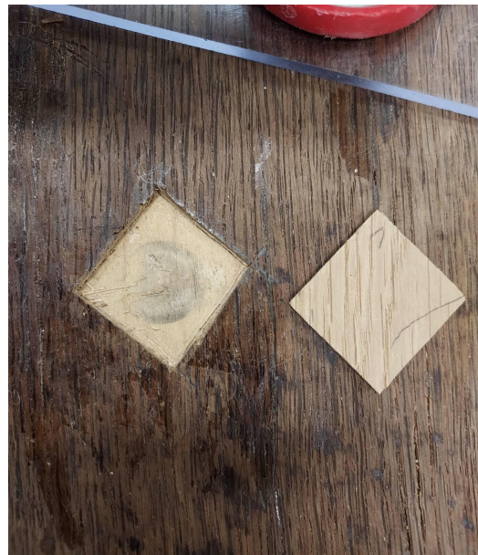
Fotod 4-5. Kapi pealisplaadi spooni parandustööd.
