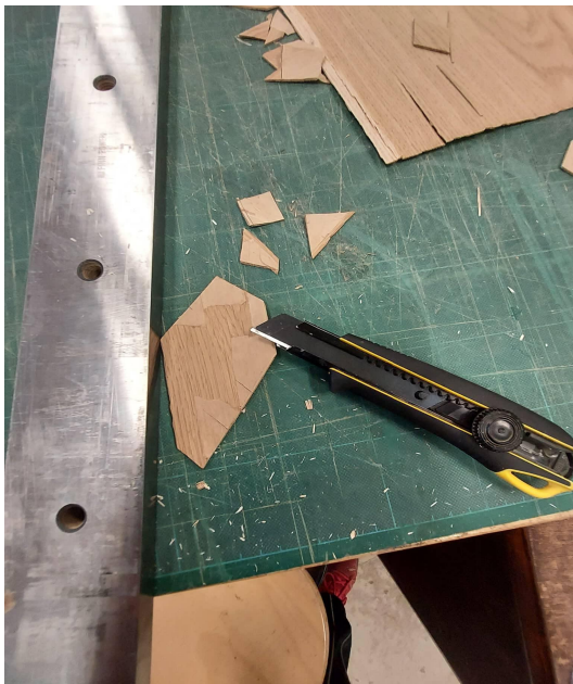
Fotod 4-5. Kapi pealisplaadi spooni parandustööd.
