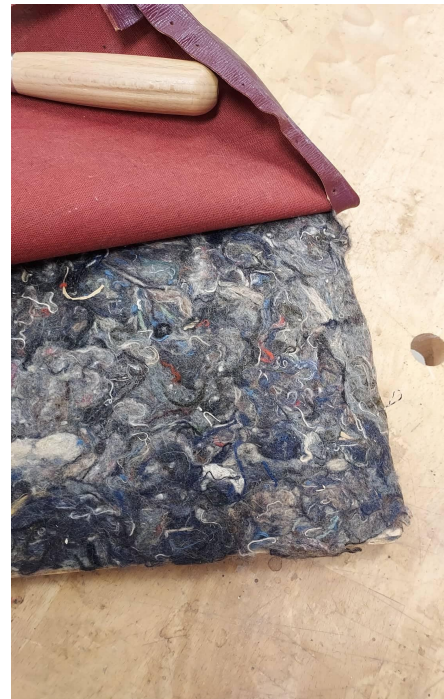
Fotod 13-14. Tooli istmeplaadi vana polster - altvaade ja sisu.
