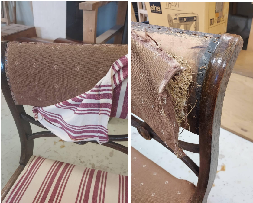
Fotod 12-13. Toolide seljatoe vana polstri eemaldamine.
