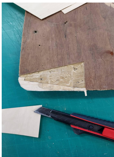
Fotod 19-22. Tooli põhja parema murdunud nurga parandamine.
