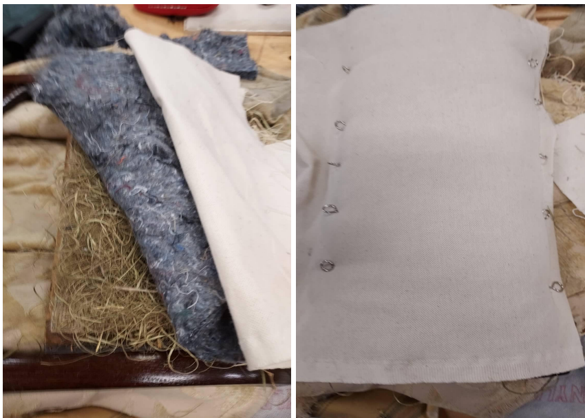
Fotod 14-17. Toolide seljatugede kõvapolstri paigaldamine.
