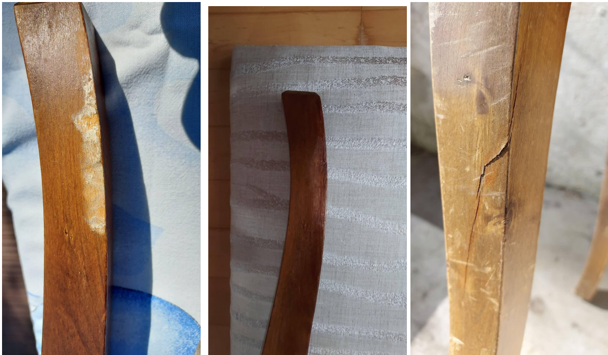
Fotod 8-9. Kahjustusega jalg enne ja pärast restaureerimist. Foto 10. Praoga jalg enne parandamist/vahaga täitmist.
