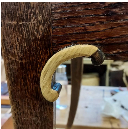
Fotod 5-10. Puidust nikerduste tegemine, toolile liimimine.
