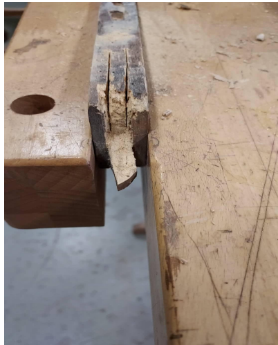
Fotod 9-10. Vasaku külje sari murdunud tapikeele taastamine.
