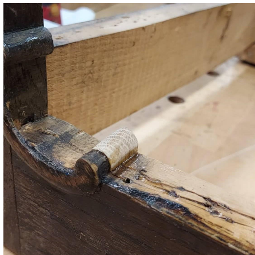
Fotod 5-10. Puidust nikerduste tegemine, toolile liimimine.
