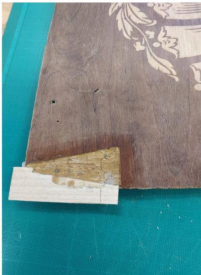
Fotod 19-22. Tooli põhja parema murdunud nurga parandamine.
