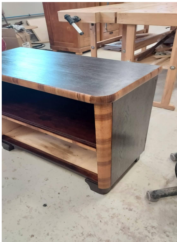
Foto 16. Kapp on peitsitud, lakitud ja poleeritud. Peaaegu valmis!
