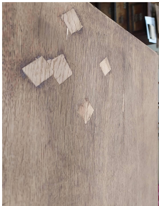
Fotod 6-7. Kapi pealisplaadi spooni parandustööd.
