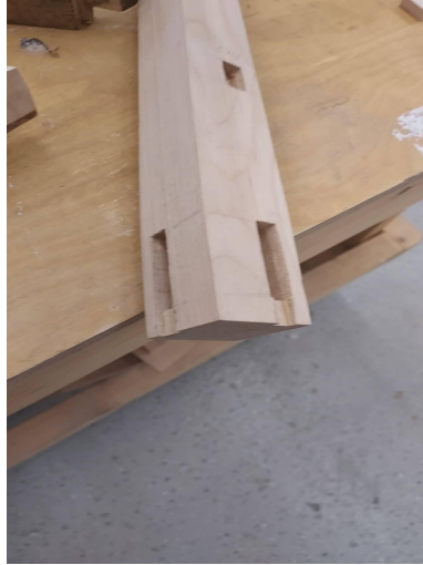
Fotod 7-8. Puuduva vasaku esijala valmistamine.
