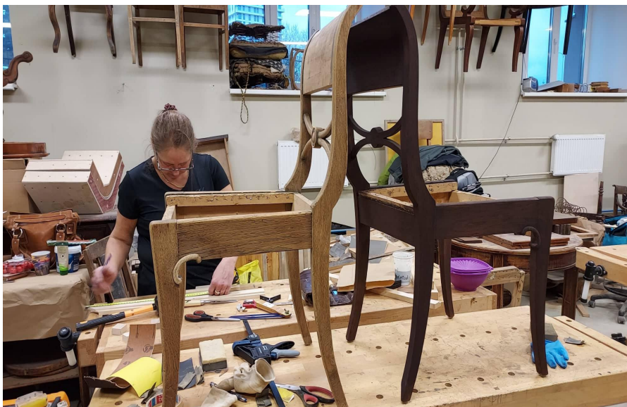
Foto 11. Viimistlemine hoos. Vasakpoolne tool on lihvitud, parempoolne juba ka peitsitud.
