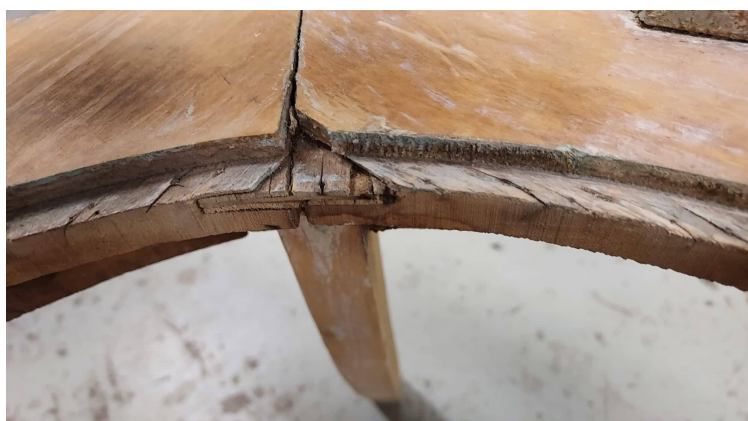
Foto 9. Tooli raami kahjustused istumisplaadi all.
