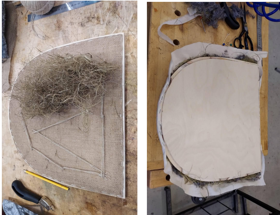
Fotod 15-16. Tooli uue polstri osa valmistamine.
