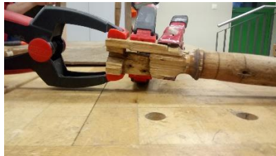
Pilt 12–21, puitosade parandamine ja asendamine
