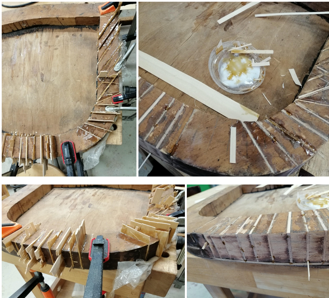
Fotod 20-23. Toolipõhja täidetud sisselõiked
