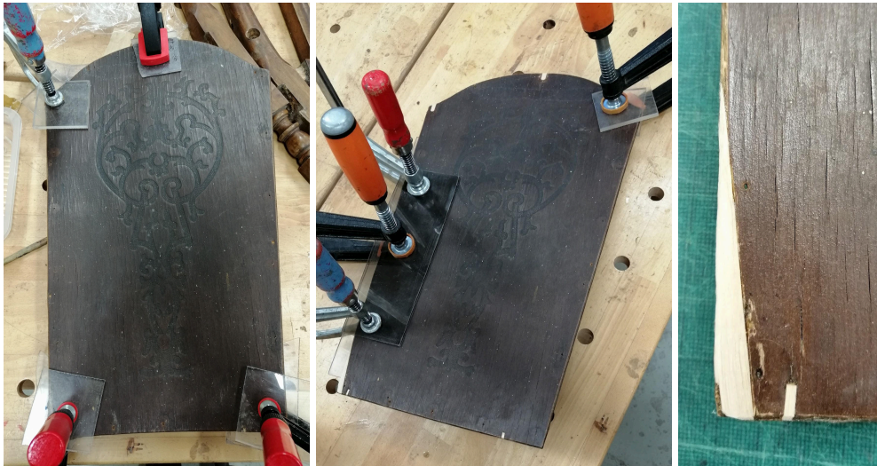
Foto 8-10. Seljatoe vineeri kihid ja spooni parandused pitskruvide vahel
