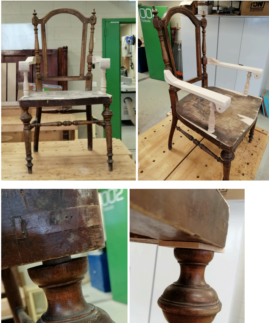
Fotod 42-45. Tooli kuivalt kokkupanek ja esimese parema jala plomm
