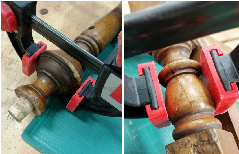
Foto 11-12. Karkassi treitud detailide liimimine
