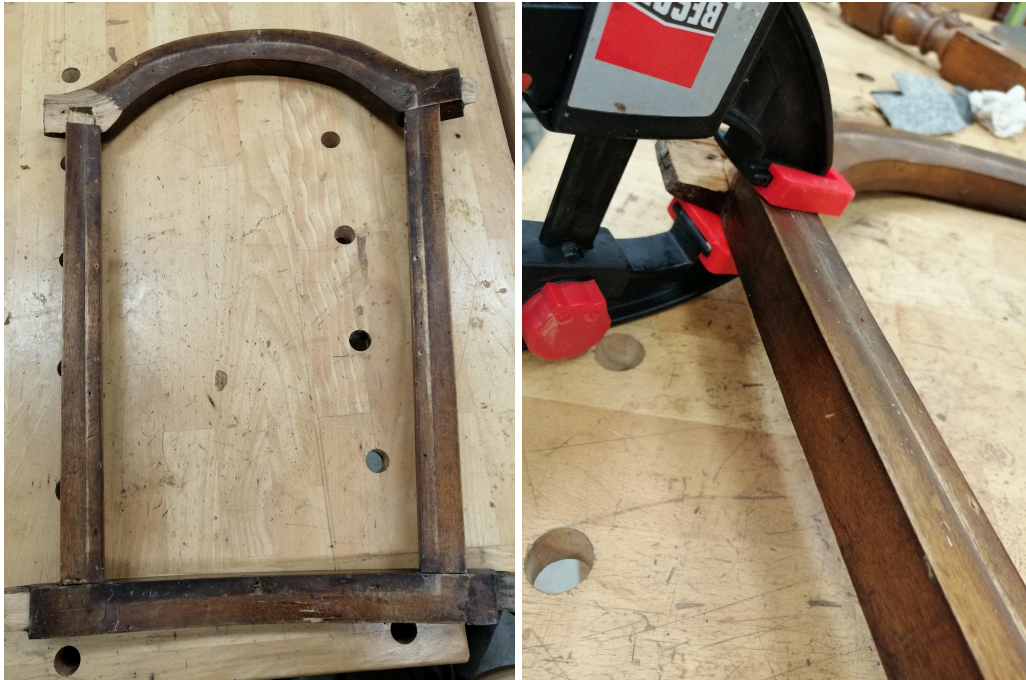
Fotod 24-25. Seljatoe vineeri raami tappide kinni liimimise protsess poole peal
