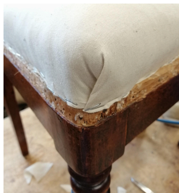
Fotod 103-106. Teise kihi meriheina ja halli vatiga polstri ülesehitamine ja mitkaliga katmine
