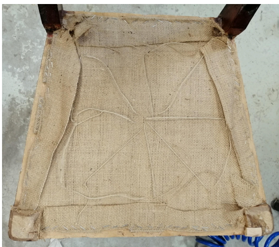
Foto 85. Istum'israamile on kinnitatud naelte ja klambripüstoliga rihmad
