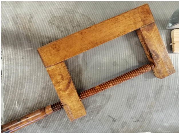
Foto 81. Vahaga kaetud puidust pitskruvi
