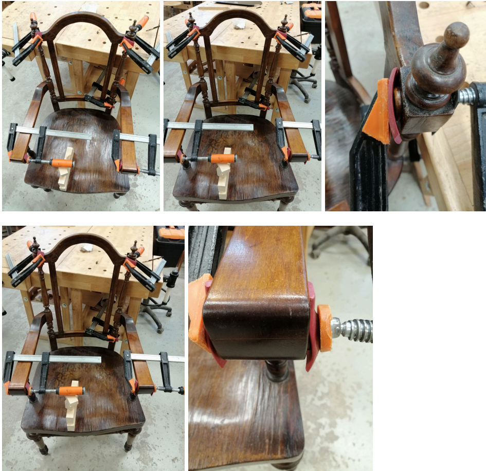
Fotod 65-69. Ringikujuliste detailide tooli külge liimimine
