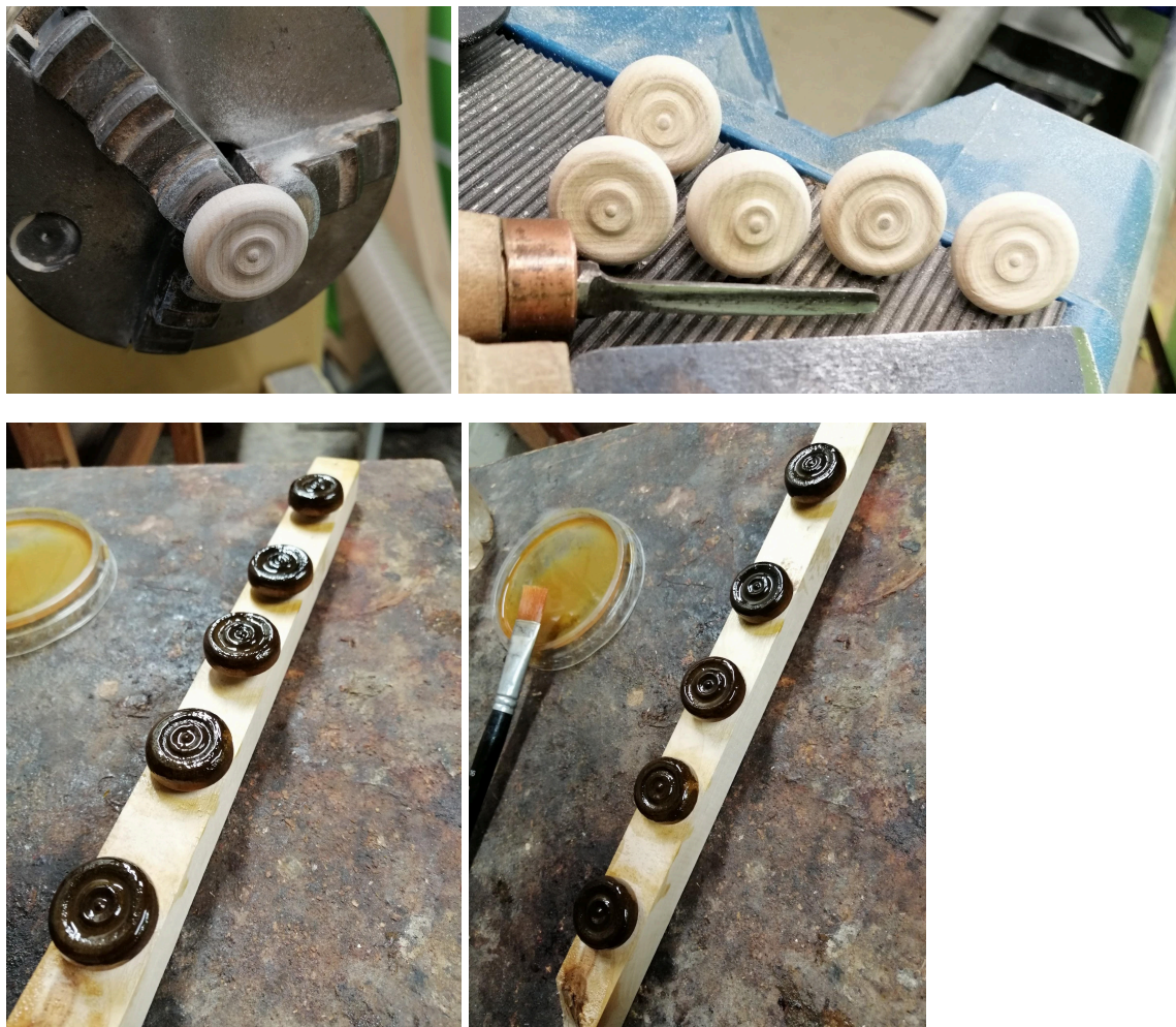
Fotod 61-64. Ringikujulised detailid enne ja pärast viimistlust
