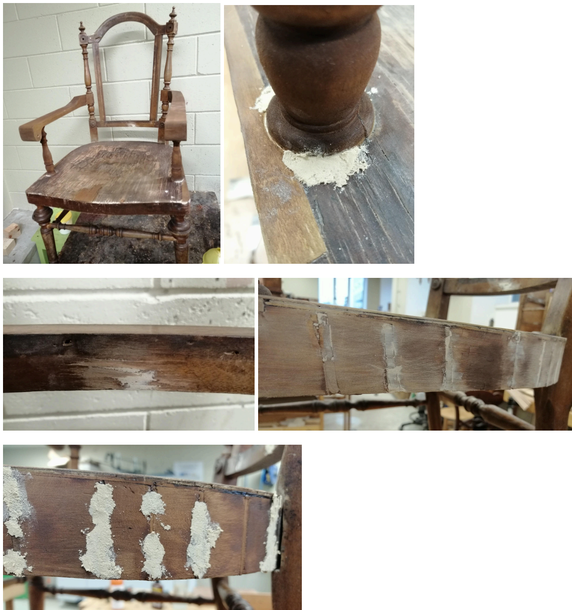
Fotod 50-54. Peitsitud ja pahteldatud tool
