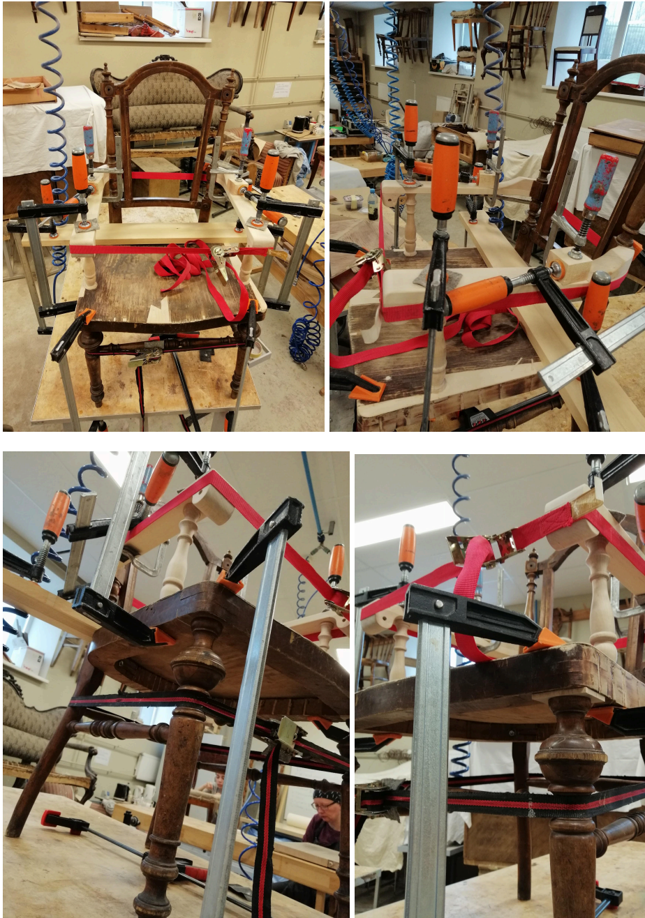
Fotod 46-49. Tooli raamistik kokkuliimimisel
