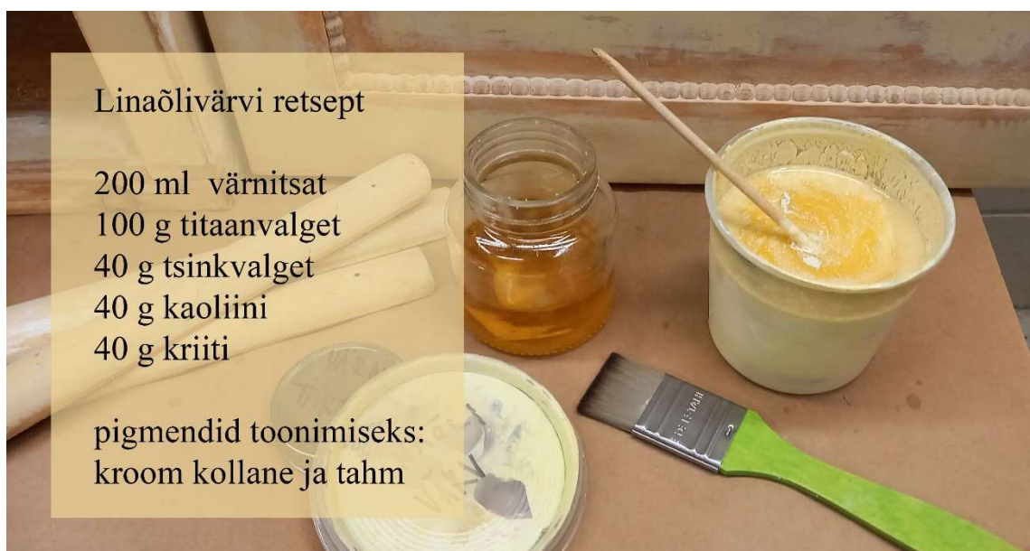
Foto 79 – Valmis segatud ja toonitud linaõlivärv koos retseptiga
