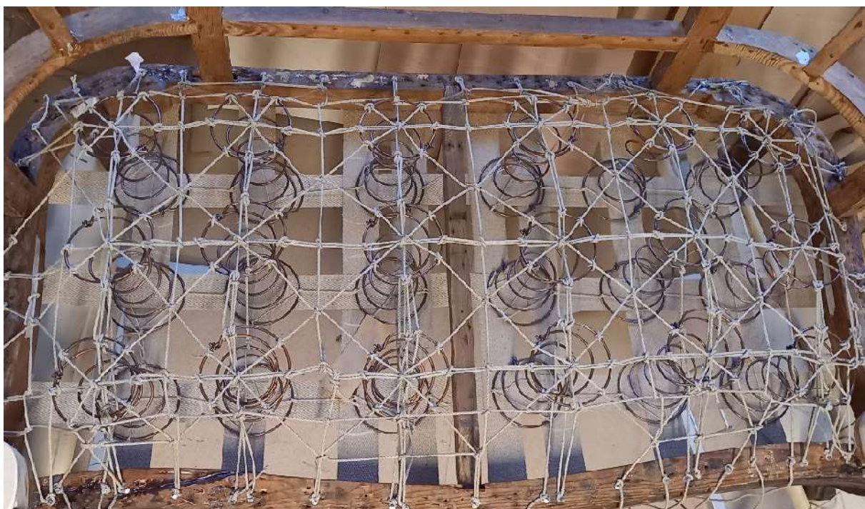
Foto 142 -- vedrud on rihmadele kinnitatud ja asendisse seotud. Nööriist on põimitud võrgustik polstrikihi toetamiseks.
