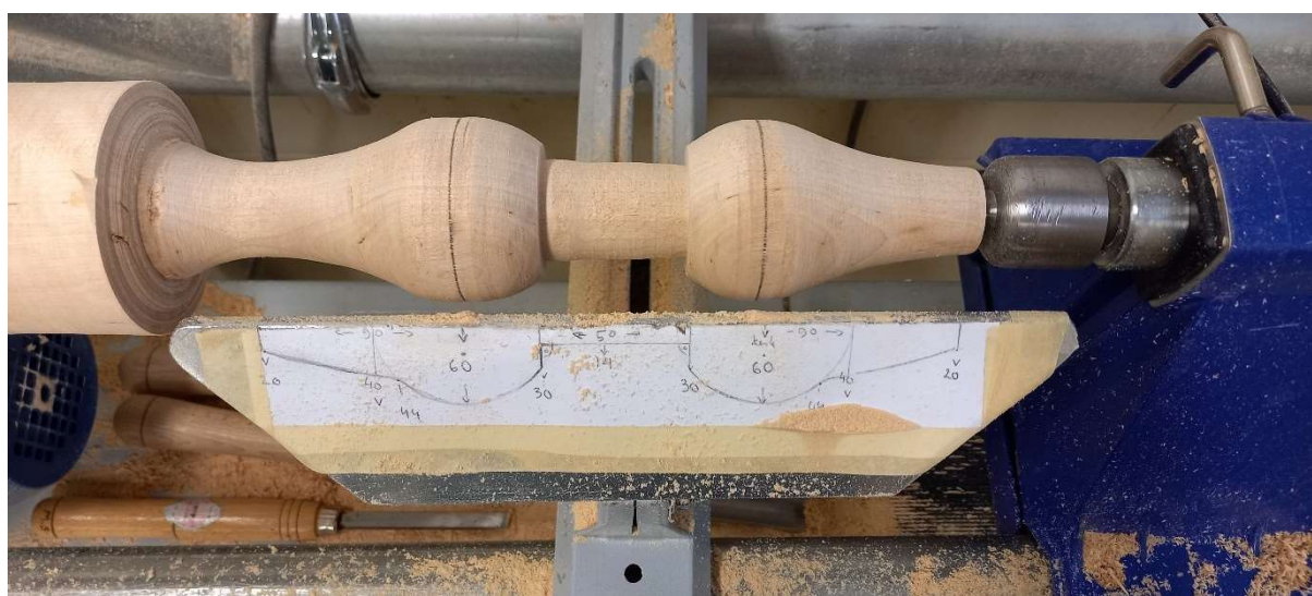
Foto 73 – Kahe esimese jala treimine. Pildil näha pooleliolev treimistöö
