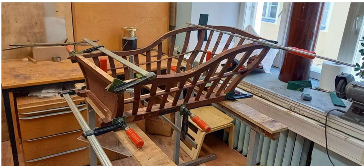
Foto 186 -- Vankri karkass on kokku moneeritud, liimi all ja pitskruvidega kinnitatud
