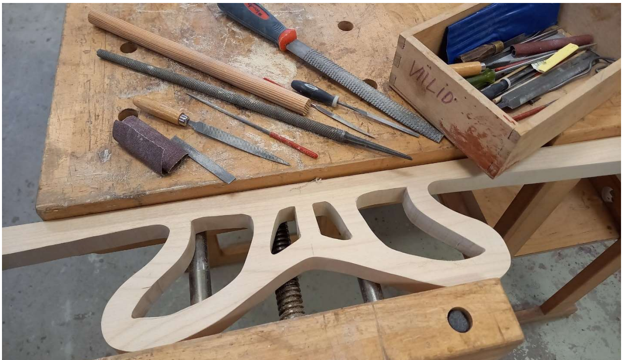
Foto 57 - Krooni lõikepindade tasandamine viili ja lihvpaberi abil
