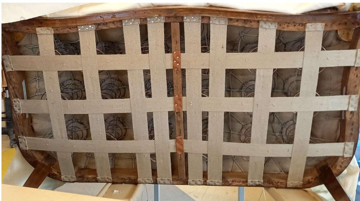
Foto 143 – diivanipõhjas on näha sadulavööd, vedrud ja vedrude peale tõmmatud alusriie
