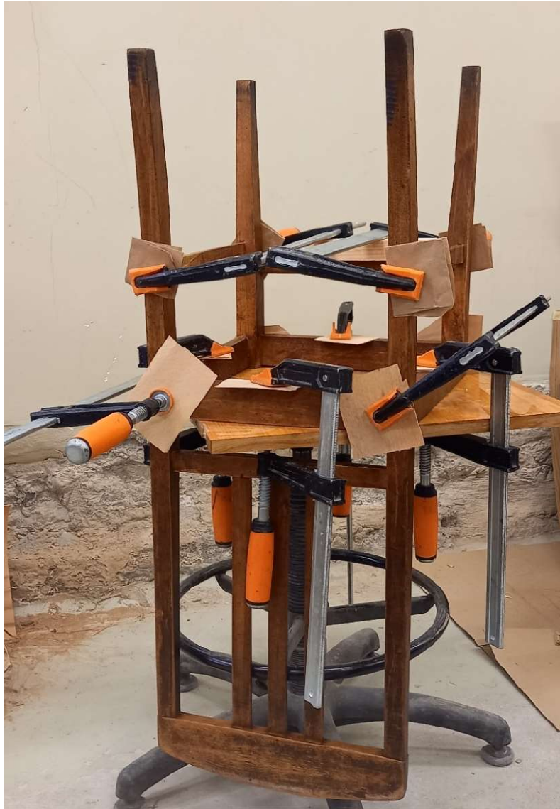
Foto 109 - tooliraam on liimi all ja pirskrudega kokku pressitud
