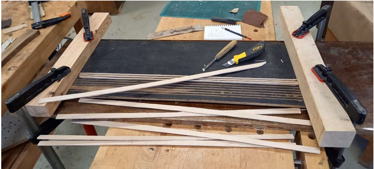
Foto 58 - Kõmmeldunud lauaplaadi sirgendamiseks vajalike liistude soontesse sobitamine
