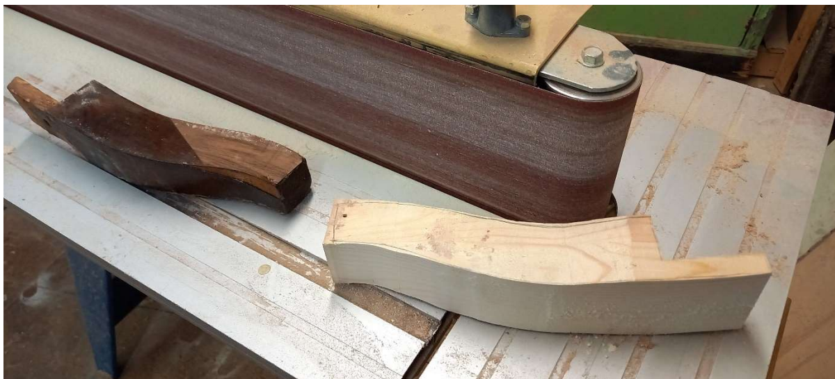
Foto 127 – uue jala lihvimine lintlihvmasina abil
