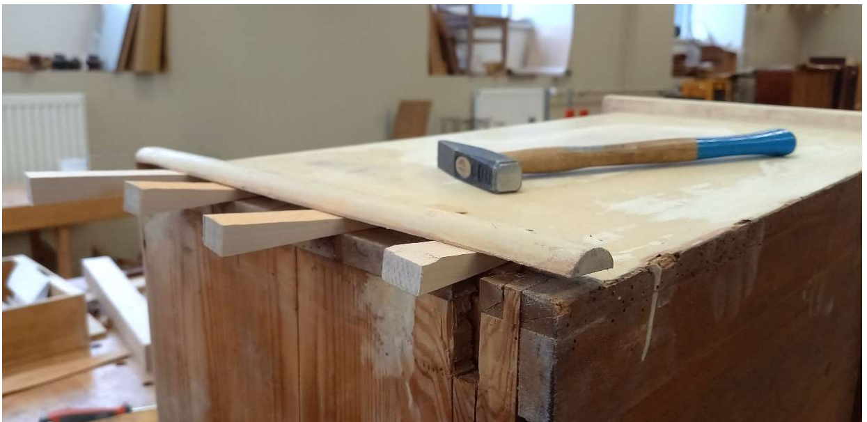
Foto 75 – Puidust kiilud abil on kapi küljes olevat liistu turvaline eemaldada
