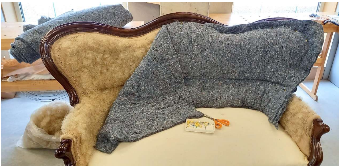
Foto 157 – diivani seljatoe polstrist on näha hobujõhv ja selle peale laotatud hall vatt
