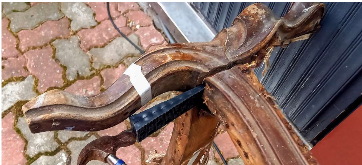
Foto 118 – diivani jala eemaldamine raami küljest kiilu abil
