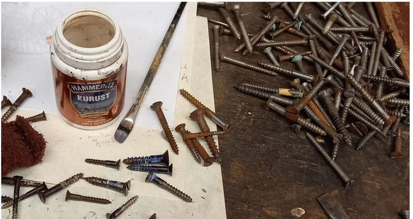
Foto 180 – Roostes kruvide katmine roostemuunduriga
