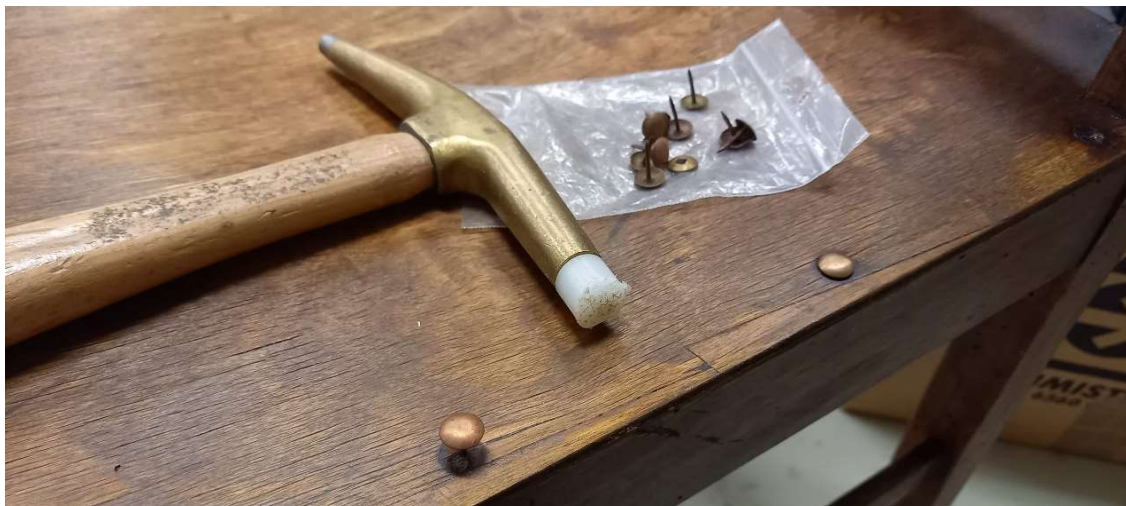
Foto 110 – ilunaeltega toolipõhja kinnitamine raami külge
