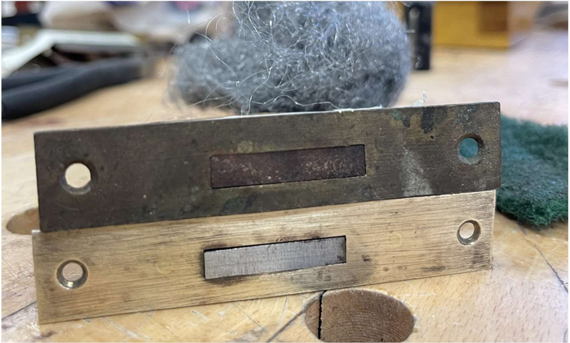
Foto 34 - : Puhastamata ja puhastatud lukuplaad
