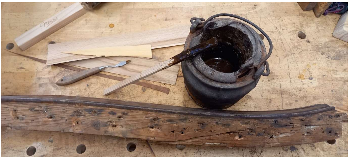
Foto 126 – kondiliim on paraja konsistentsiga, kuum ning valmis lõhesse valamiseks
