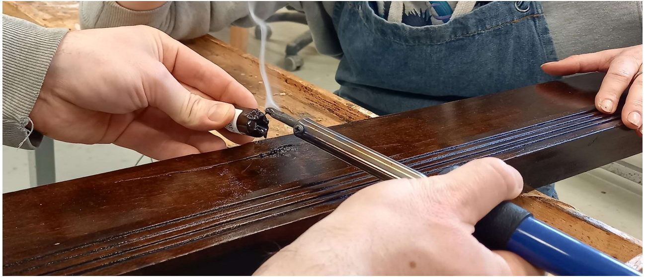
Foto 61 Foto 62 - Laki sulatamine jootekolbi abil
