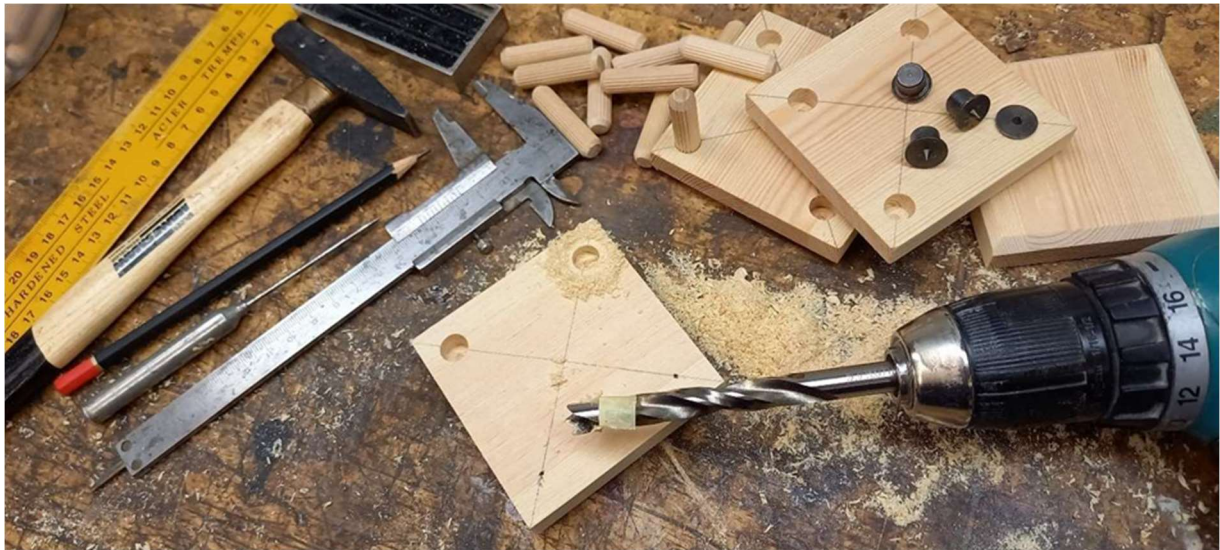
Foto 199 – Avade puurimisel on puuri ots märgistatud, et ava jääks sobivale kõrgusele
