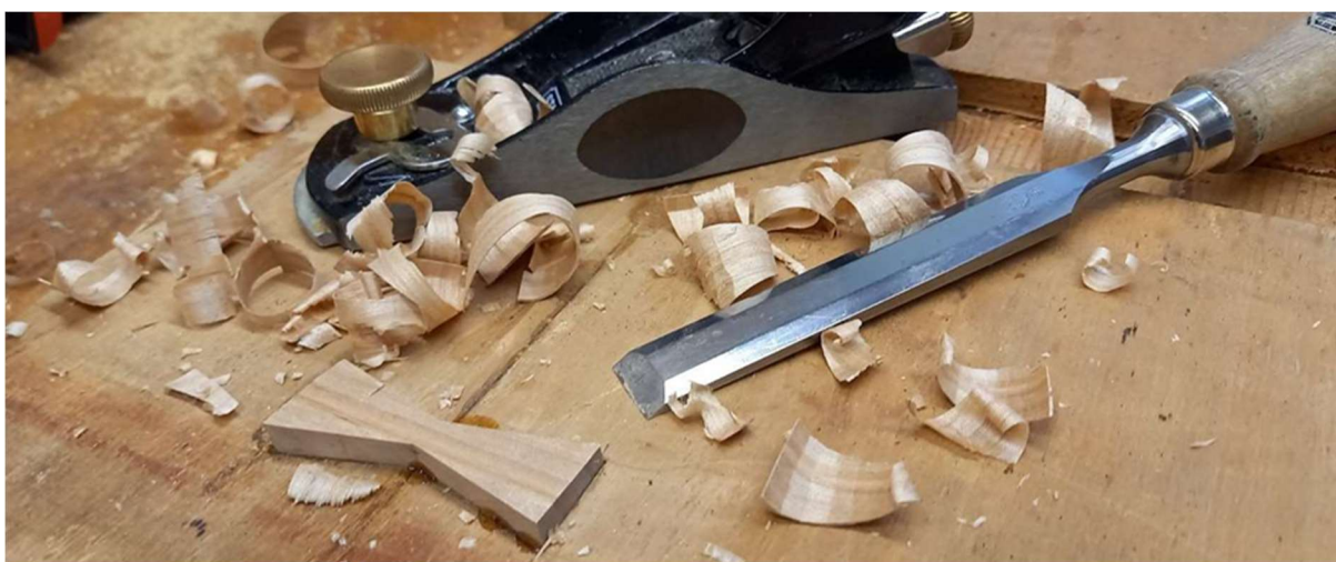
Foto 226 - panustükk on liimitud plaati sisse tehtud avasse, toimub paksuse maha hõõveldamine
