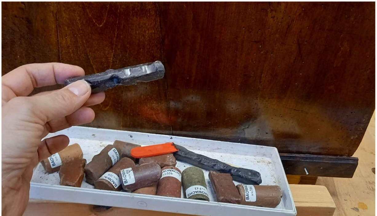
Foto 49 - Vahapulkadega pinnal väiksemate defektide peitmine
