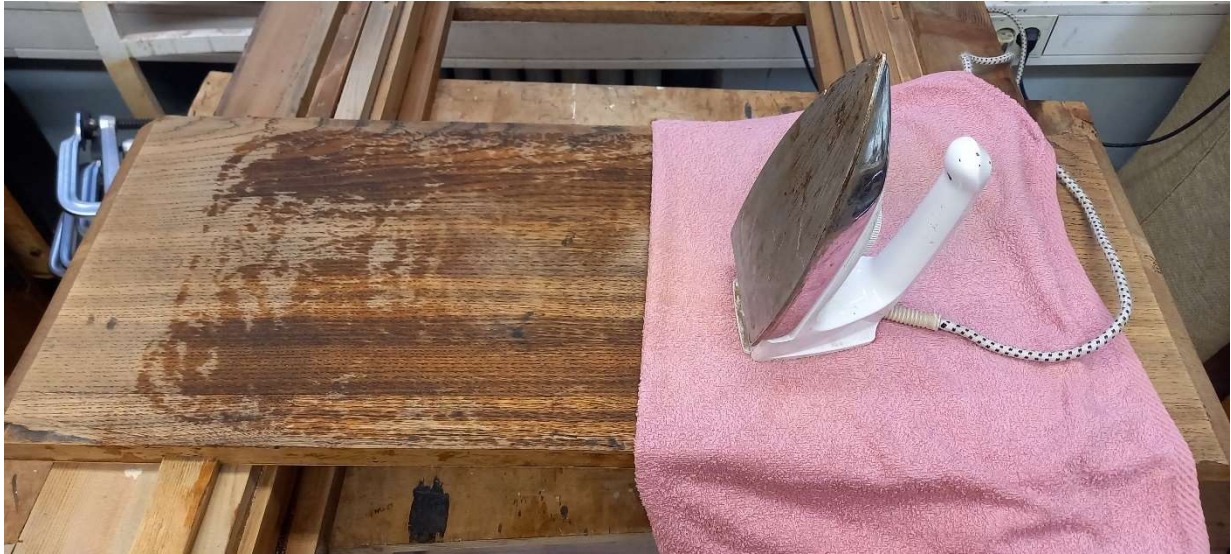
Foto 223 – spooni pinna niisutamine märja rätiku ja triikraua abil
