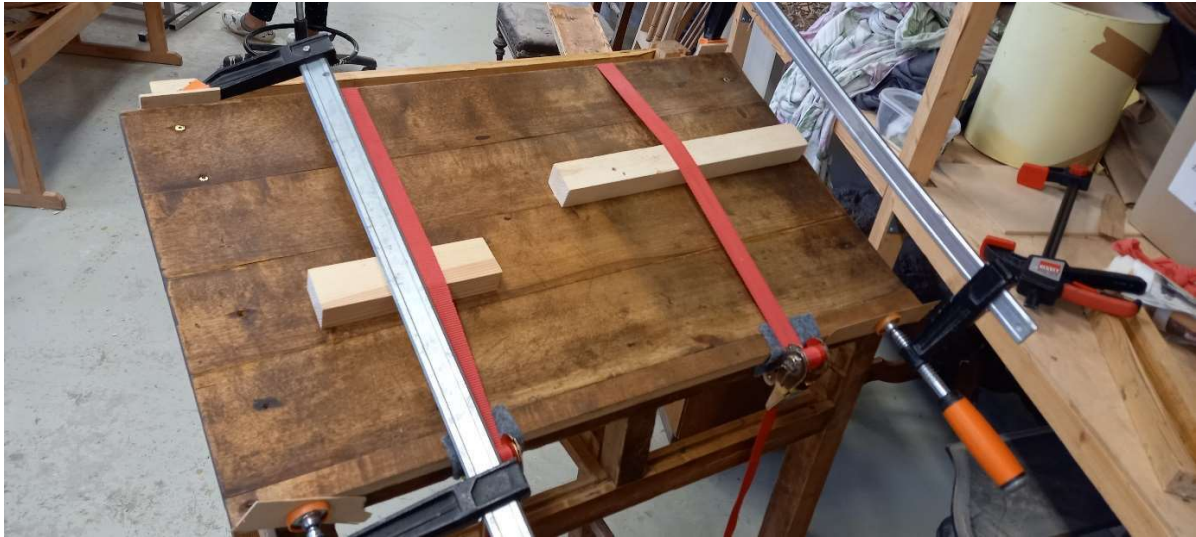
Foto 92 - Lauaplaat on surutud veorihmadega raami külge kuni liimi kuivamiseni
