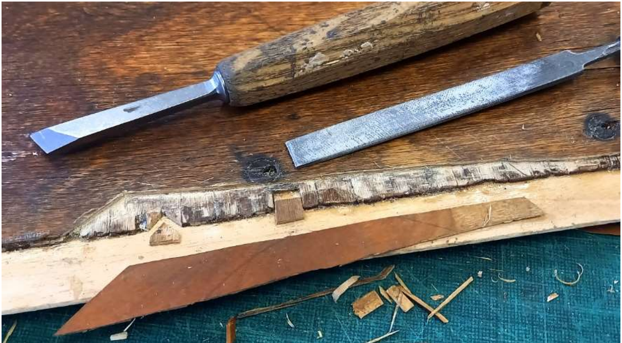
Foto 104 - spooniparandus toolipõhja keskmisel kihil
