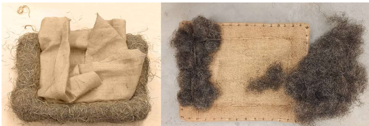
Foto 24 – vasakul on näha meriheinaga täidetud pind, pealmine juteriie on kandi tihendamiseks lahti võetud ning sinna on pandud lisakogus meriheina. Parema on näha et meriheinaga täidetud osa, samuti kant on tihedalt läbi õmmeldud, toimub hobujõhvi paigutamine.
