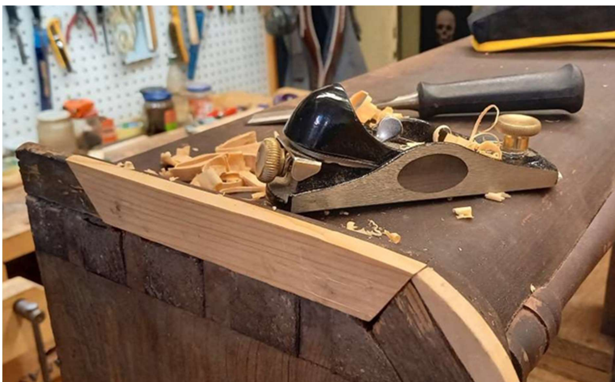
Foto 202 – panuse tasandamiseks on kasutatud hõövlit
