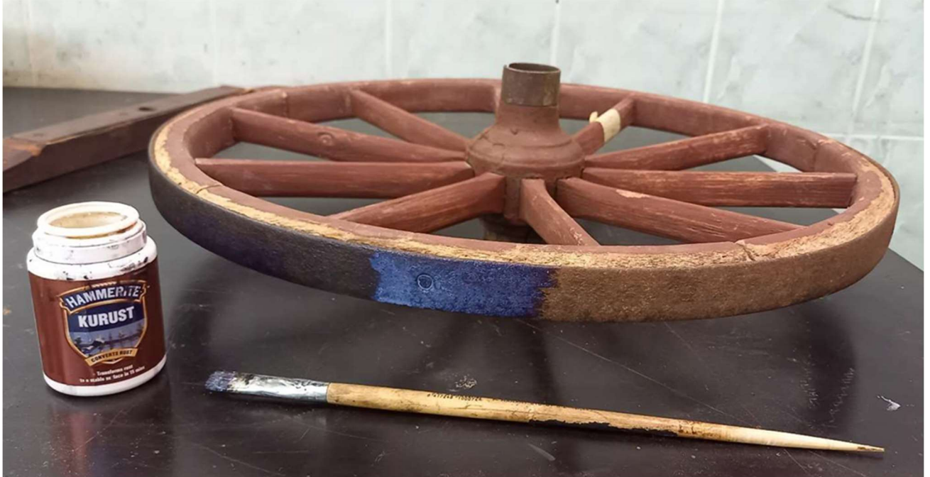
Foto 179 – Vankri rataste metallosade katmine roostemuunduriga
