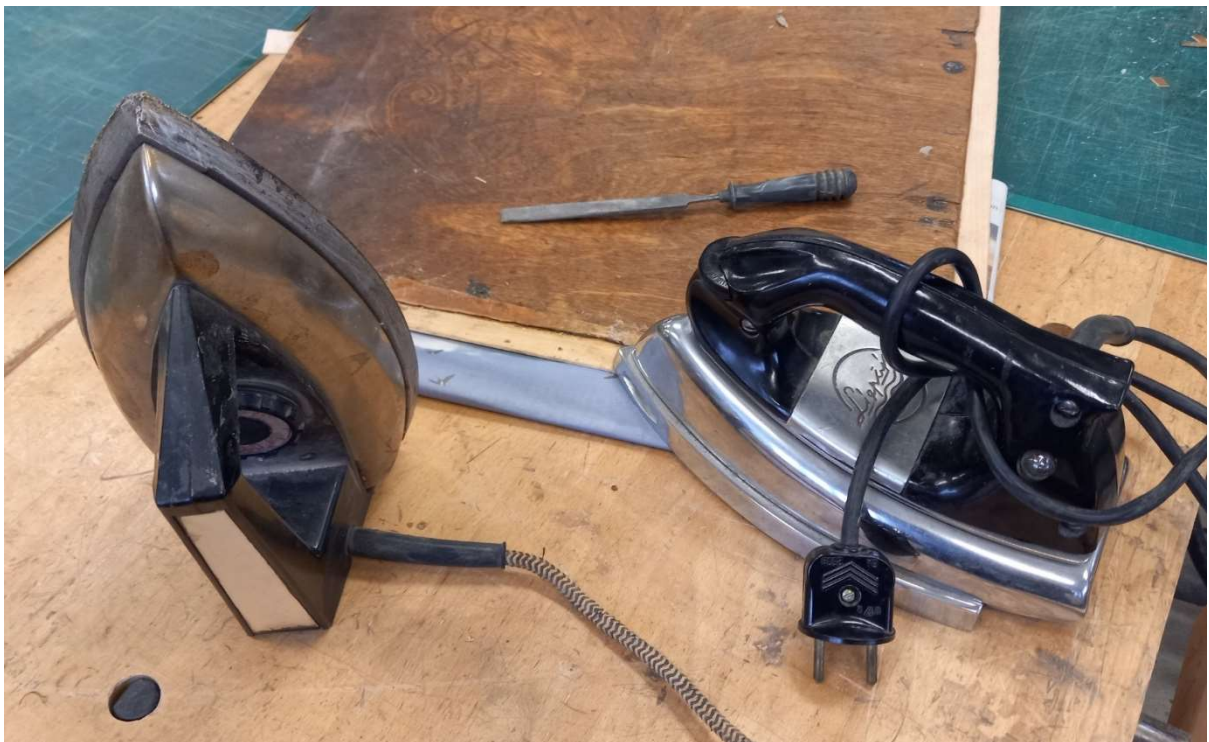
Foto 103 – vineerimisel kasutasin spooni kinnitamiseks kuuma triikrauda liimi aktiveerimiseks ja külma triikrauda liimi jahutamiseks. Sel moel toimides polnud vaja vineeritud tükki surve all kuivatada.
