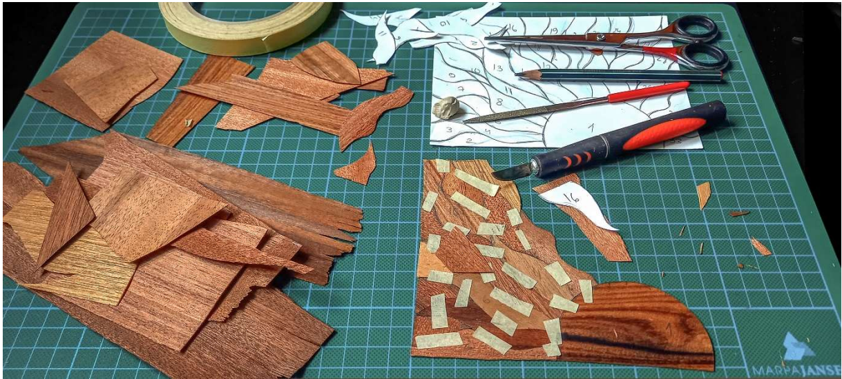
Foto 19 – spooni joonise järgi välja lõikamine ja kokku sobitamine spoonisärgiks
