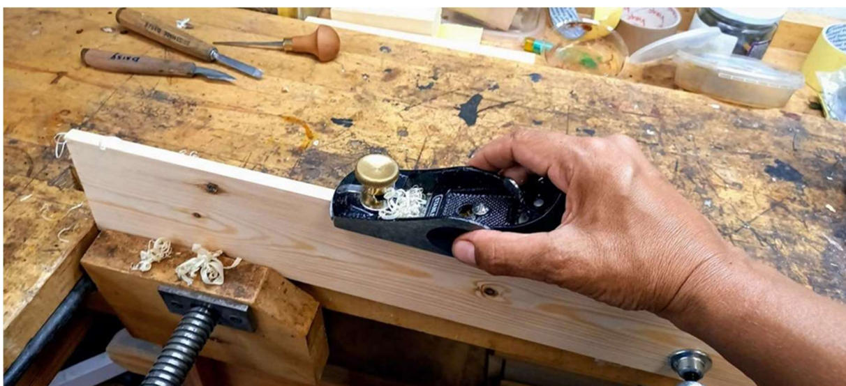
Foto 184 - Vankri põhjalaua mõõtu hõõveldamine
