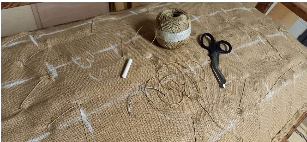
Foto 144 – kangas on vedrude külge õmmeldud. Kriidiga on joonistatud täiteasade kohad
