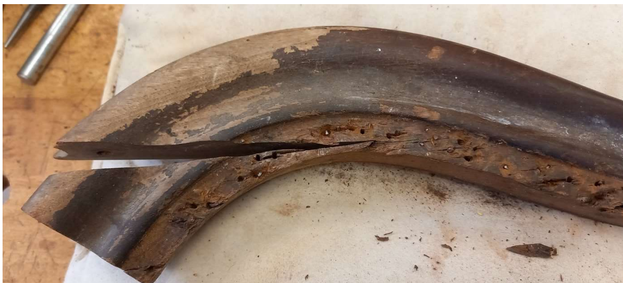
Foto 124 – lõhega seljatoe kaare detail enne parandamist
