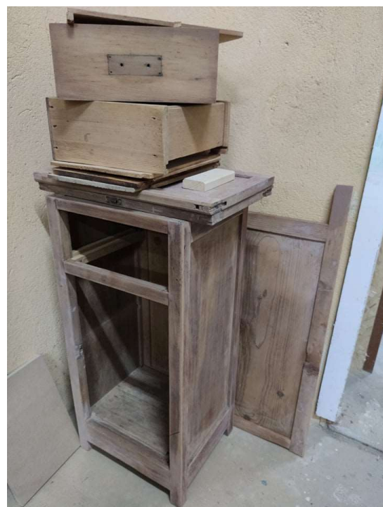
Foto 240 – öökapp on osadeks võetud ja lakk maha lihvitud
