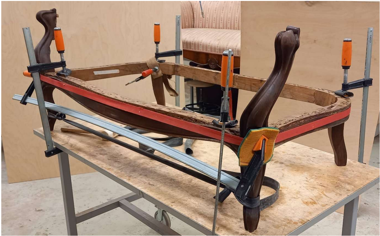
Foto 132 – alusraam ning jalad on ühendatud ning surutud lauaplaadi külge.
