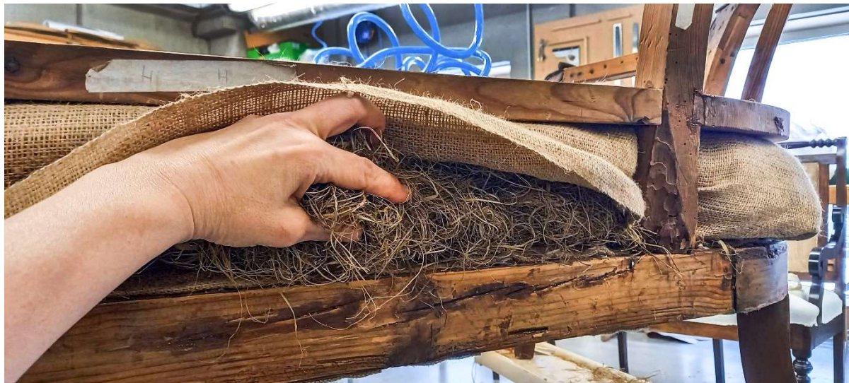
Foto 146 – läbiõmmeldud kanga serv on avatud ja sinna on surutakse lisakiht meriheina
