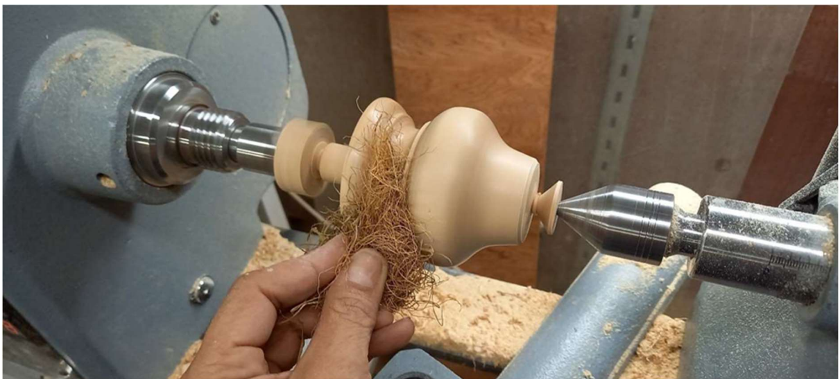
Foto 218 – Valmis treitud lauajala poleerimine treipingis meriheinaga
