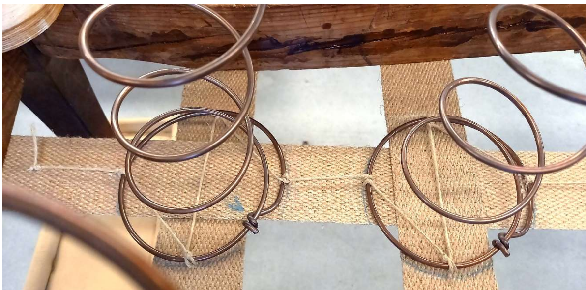
Foto 140 – vedrude asendise sidumisel olid abiks skeemid ja joonised
