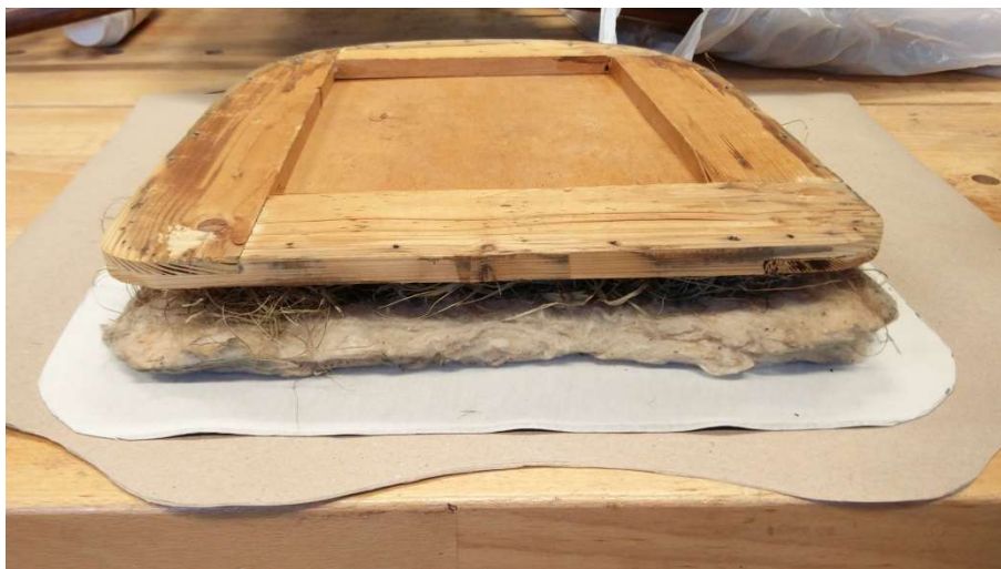
Toolipõhja polsterdamine, uue katte lõikamine
