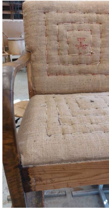
Seljatoe poolpehme ja istmeosa pehmepolstri valmimine
