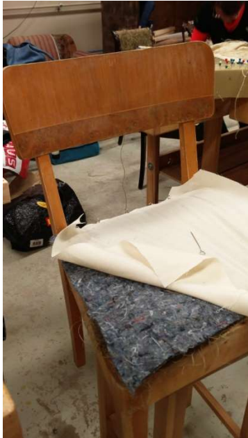
Kõvapolstri valmistamine, aluskanga paigaldus
