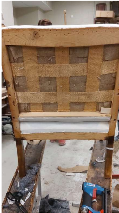
Seljatoe poolpehme ja istmeosa pehmepolstri valmimine
