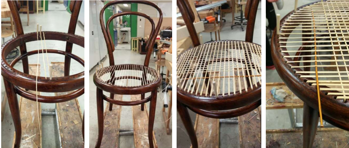
Rotangpõhja punumine, abiks puidust punnid ja varras.
