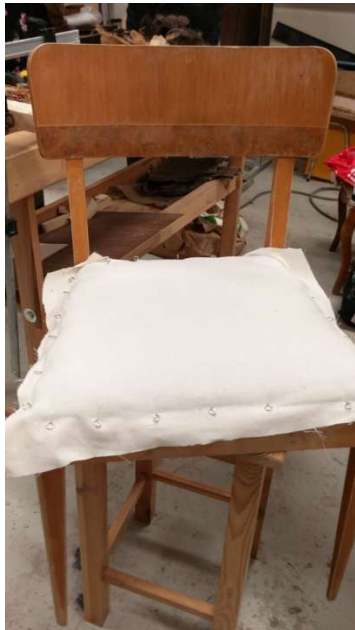
Kõvapolstri valmistamine, aluskanga paigaldus
