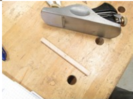
Kinnitatud liimi ja tüüblitega. Tüüblid 9mm.st pulgast pihuhöõvliga 6 mm. Mõõtu.
