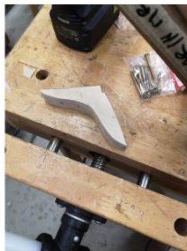
Toolipõhja nurgatugede saagimine, lihvimine ja asendamine uutega
