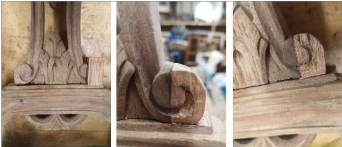
Tool seljatoe trofeeosale parandustüki peiteldamine: voluudi parandustöö
