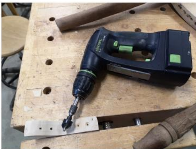
Toolipõhja nurgatugede saagimine, lihvimine ja asendamine uutega
