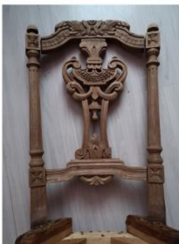
Seljatoe piitade liimimine tappidest ja trofee kinni liimimine
