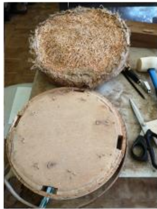
Polstrikihtide avamine ja hindamine: otsustati alles jätta heas korras olev vana polstripadi. Lisada on vaja uus tasanduskiht ja teha uued kandi- ja läbiõmblused.
