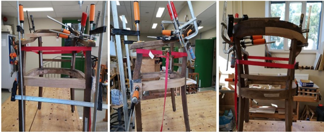
Tooli kokku liimimine ja fikseerimine pitskruvide ning koormarihmaga
