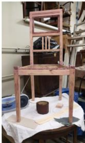
Toolsi korduv lihvimine pärast keemilist puhastust. Peitsimine.
