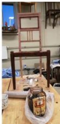
Toolsi korduv lihvimine pärast keemilist puhastust. Peitsimine.
