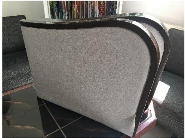
Käetugede välisküle alumine serv on jäetud lahti, käetugede tugitooli külge kruvidega kinnitamiseks
