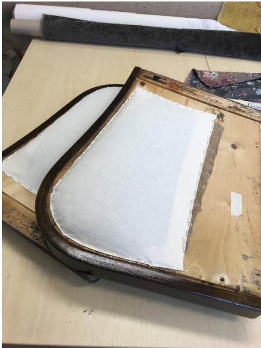
Käetoed valmis pealisrüide paigaldamiseks
