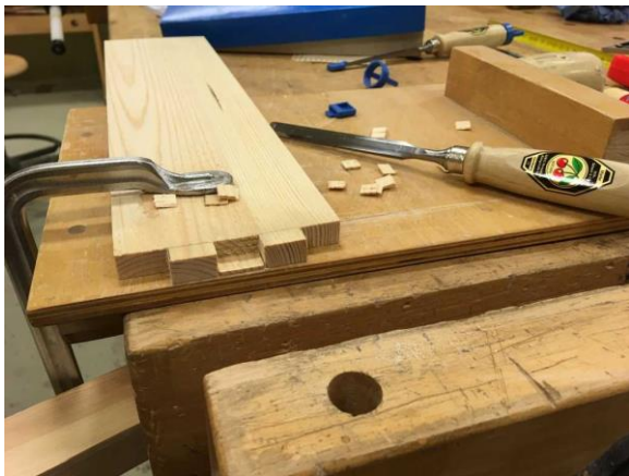
Uue sahtli valmistamise protsess
