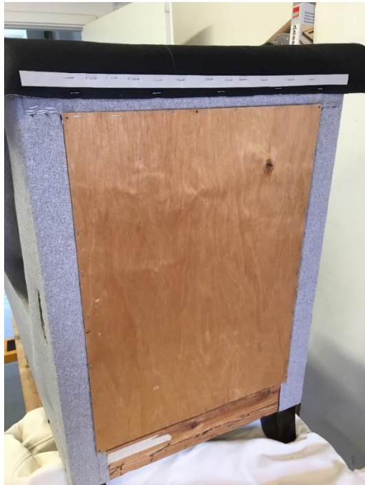
Seljatoe tagumise kanga paigaldamine (papist liistuga ülaserva kinnitamine)
