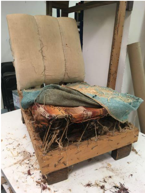
Istmeosal oli 12 vedru, mis restaureerimise käigus asendatakse uute 8 keeruste vedrudega.
