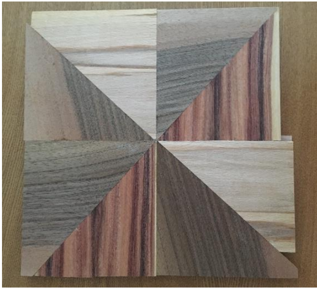
Intarsiatehnikas kella valmistamine (kasutatud pähkli, tamme ja roosipuu spooni, kaetud šellakiga)
