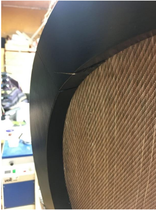
Seljatoe polstri aluskanga paigaldamise käigus seljatoe raami tekkinud pragu ja selle liimimine
