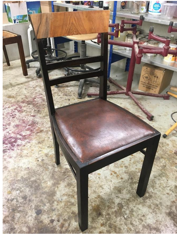
Peitsiparandused ja dermatiitkatte kahjustuse peitmine tehtud. Spooniparandus tuleb veel saada vana spooniga ühtlasesse tooni.
