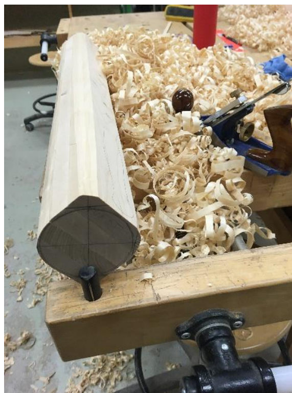
Liimpuidu ümaraks hõõveldamine
