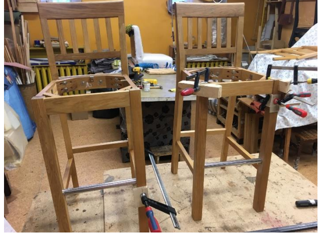
Kaasaegsete puktoolide tappide liimimine
