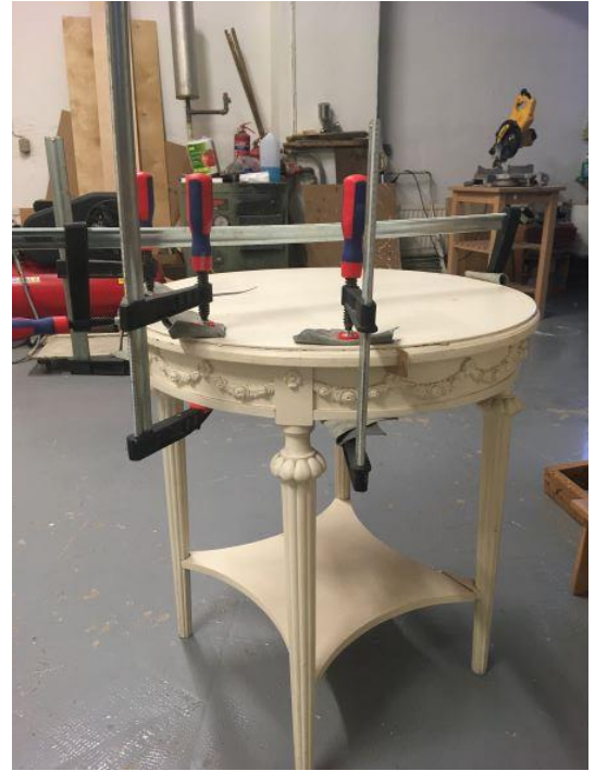
Plaadi liimimine tagasi raami külge
