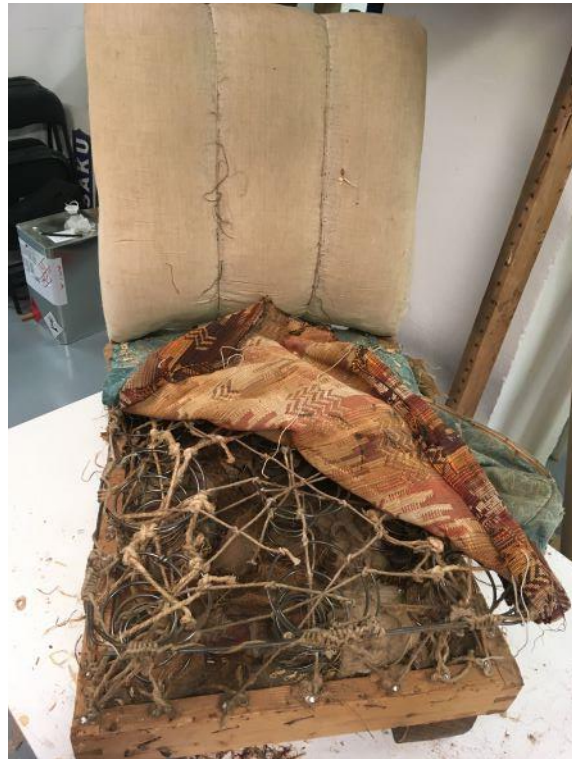
Istmeosal oli 12 vedru, mis restaureerimise käigus asendatakse uute 8 keeruste vedrudega.
