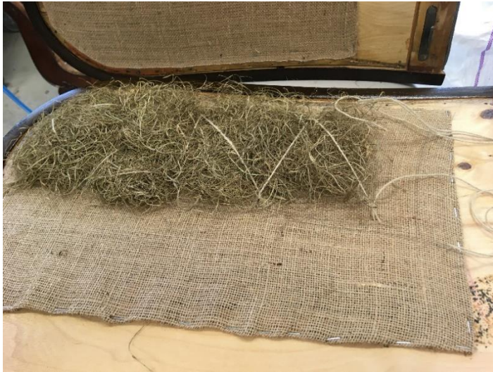
Polstripadja ehitamine käetugede sisekülgedele
