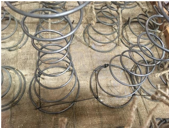
Paigaldasime 2 uut vedru ja sidusime põhjavedrud uuesti üle
