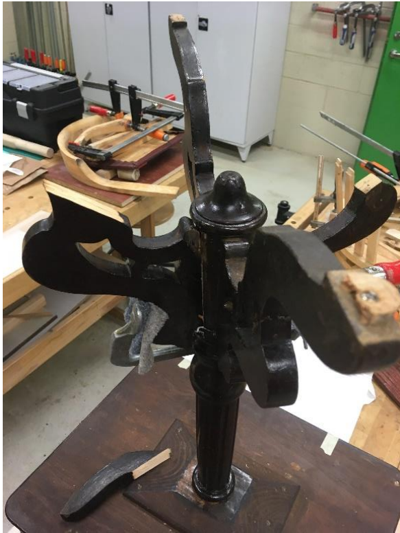
Restaureerimistöde käigus murdus ära seni ainukesena terve olnud tugijalg, piltidel näha detaili murdumispind ja äramurdunud osa tagasiliimimine.
