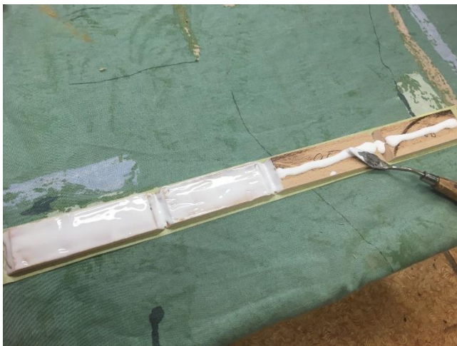
Iiri saatkonna diivani jalale uue liistu liimimine puuduoleva asendamiseks
