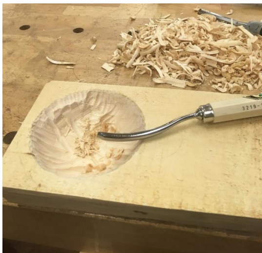
Pärna puidust kulbi valmistamine kumerpeitliga
