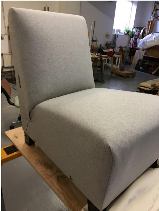
Pealiskangas paigaldatud põhjale ja seljatoe esiosale
