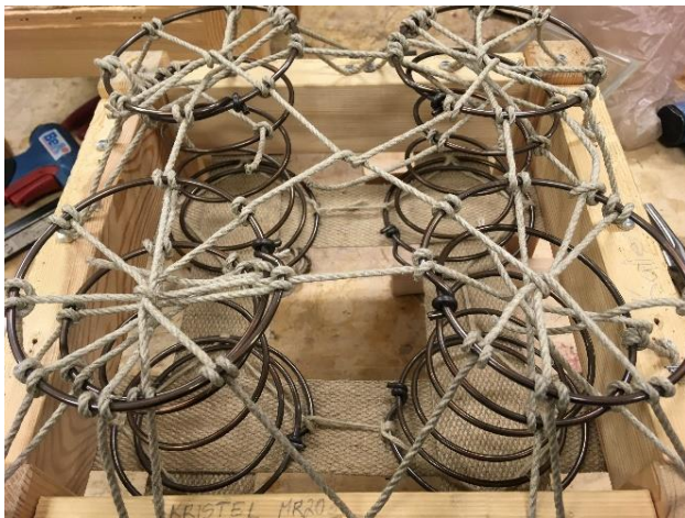
Pehmepolstri harjutustöö vedrude sidumine
