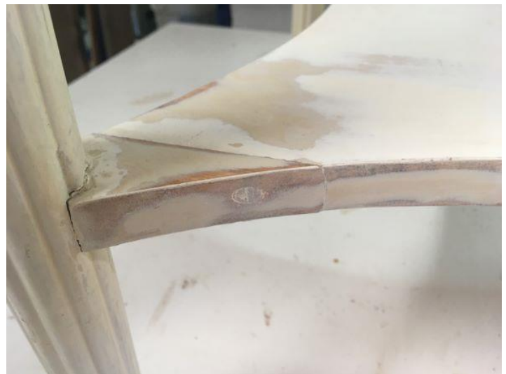
Vineerplaadi all oleva originaalplaadi lahku kuivanud välisserva praod täitsime spooniga. Alumise lauaplaadi katkised kohad liimisime ning paigaldasime tüüblid.
