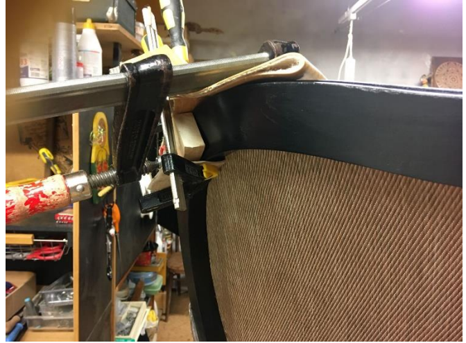
Seljatoe polstri aluskanga paigaldamise käigus seljatoe raami tekkinud pragu ja selle liimimine
