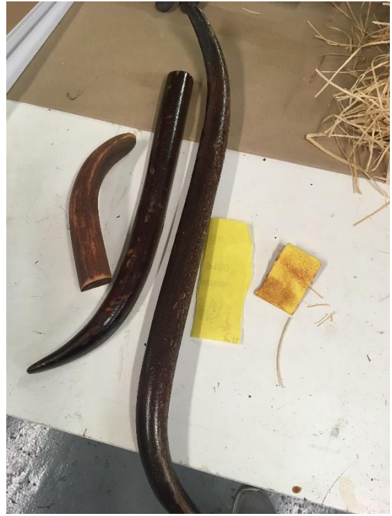
Vana laki eemaldamine puitdetailidelt
