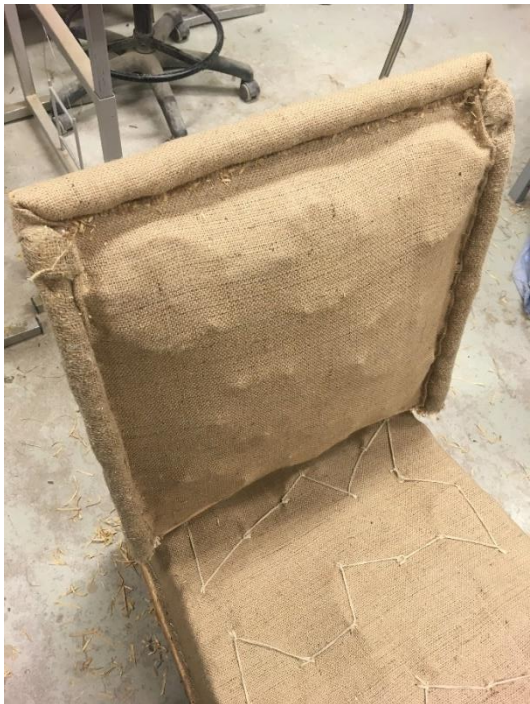
Seljatoele paigaldatud kotiräie ja uus ülemine servakant
