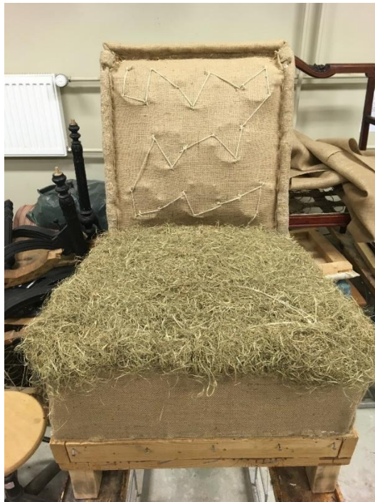
Tihiniitide vahele paigaldatud põhjapolstri merihein
