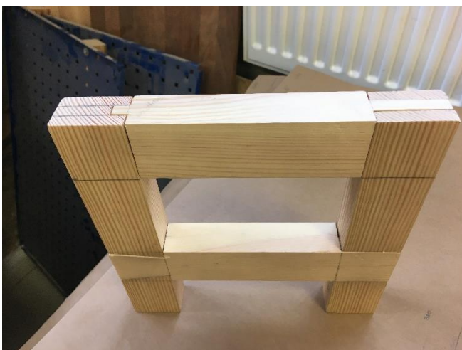
Nelja tapi raam (mitteläbiv poolpeittapp, ühe keelega harktapp, läbiv rööplukk, läbiv kalasabalukk)
