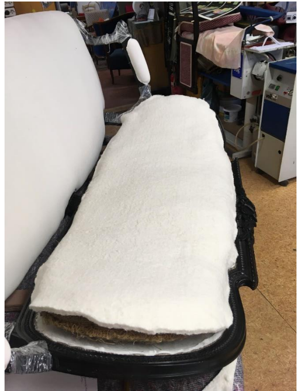
Seljatoe polstipadja (originaalpadi, hobujõhvid?) paigaldamine (alusriide külge õmmeldud) ja vatiini paigaldamine
