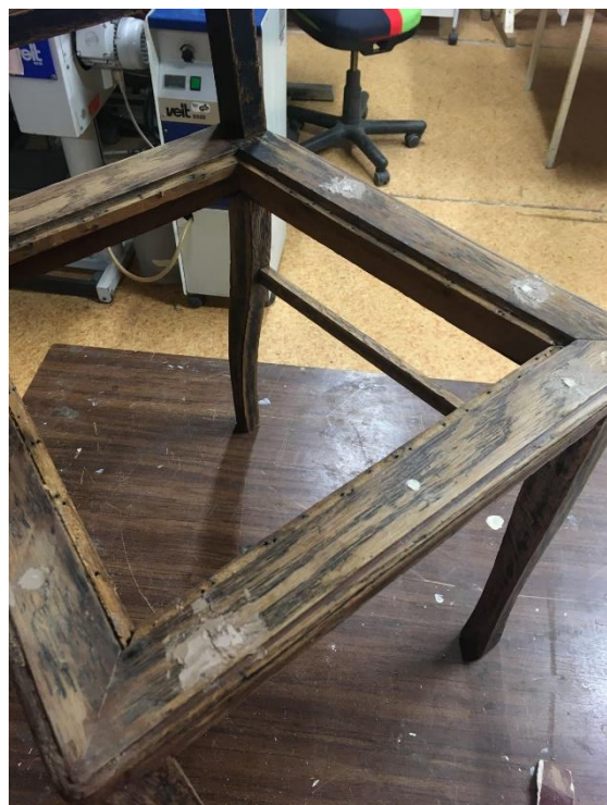
Kruviaukudesse paigaldasin tüüblid, seejärel pahteldasin
