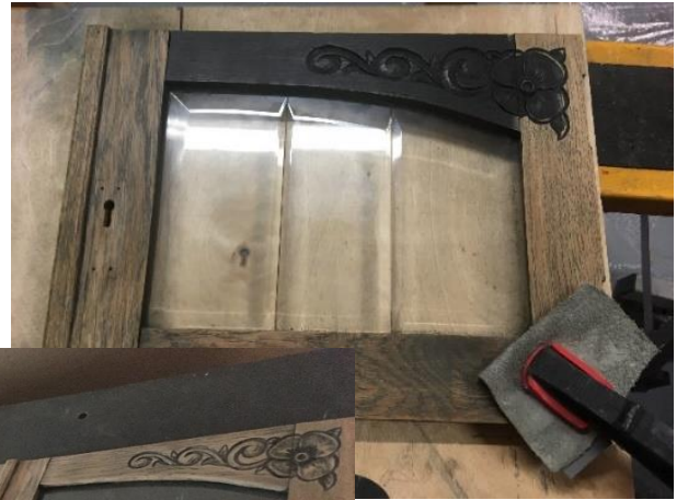
Puhvetkapi ülemise osa klaasuste puhastamine kaapelehe ja lihvpaperiga
