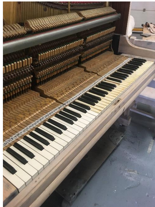
Pildidel on kujutatud puhastatud ja veel puhastamata klahvide erinevust
