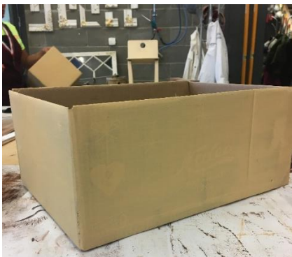
Alküüdkruntvärviga kaetud pappkast aaderduse aluspinnaks
