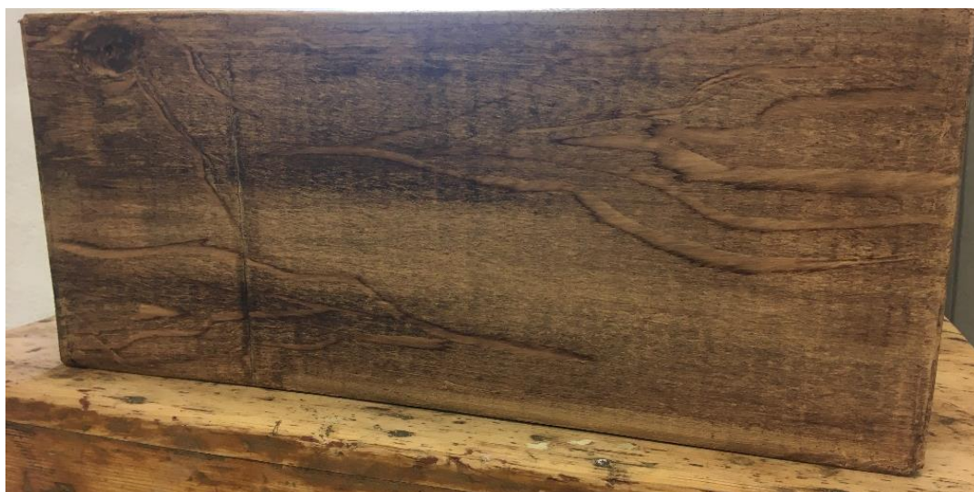
Õlleaaderdusega puiduimiteerimine pappkastil
