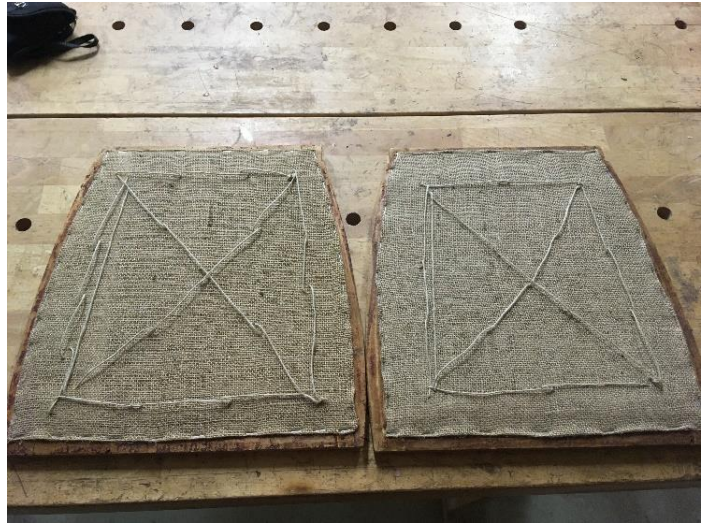
Kotiriide ja tihiniitide paigaldamine toolipõhjadele
