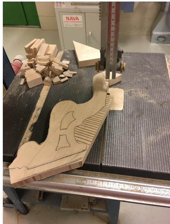
Kasepuidust laud ja šabloon, millest valmib uus ažuurne tugijalg (või selle osa); detaili väljalõikamine lintsael.
