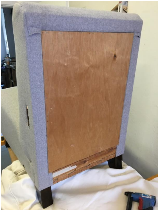
Seljatoe taha paigaldatud originaal vineerplaat
