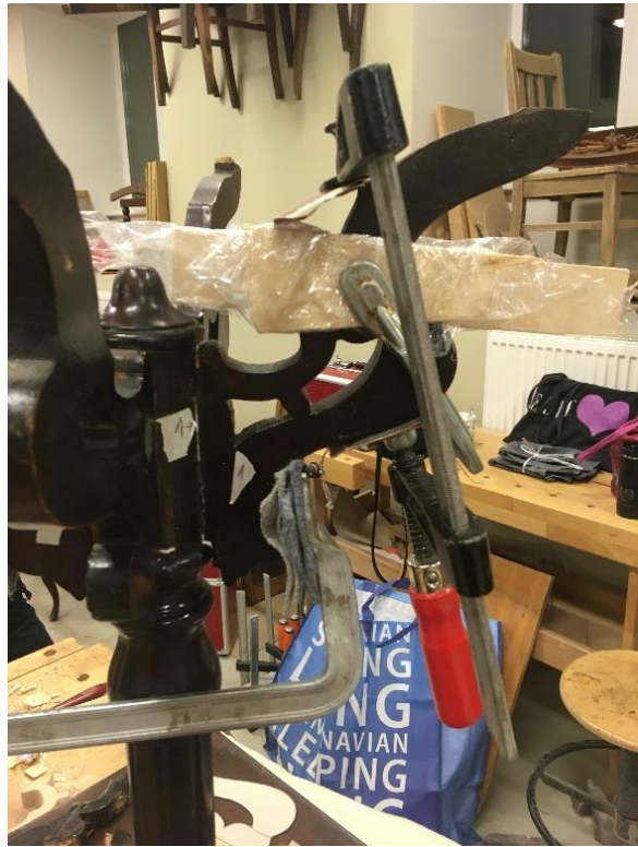
Restaureerimistöde käigus murdus ära seni ainukesena terve olnud tugijalg, piltidel näha detaili murdumispind ja äramurdunud osa tagasiliimimine.
