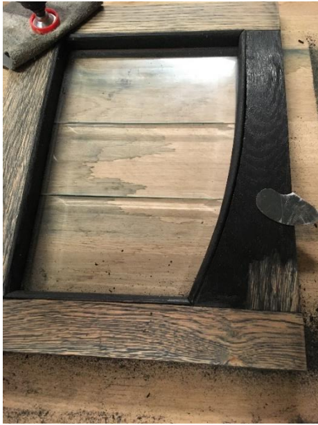
Puhvetkapi ülemise osa klaasuste puhastamine kaapelehe ja lihvpaperiga
