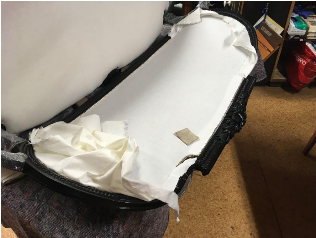
Polstri aluskanga paigaldamine (kuna tegemist on tagant lahtise seljatoega, siis aluskanga alla on juba paigaldatud dekoratiivkangas, mis jääb diivani tagant näha)
