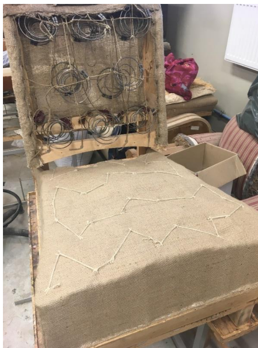
Kotiriide paigaldamine seotud põhjavedrudele
