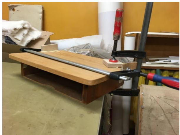
Lahtise spooniliistu liimimine ja spooniparanuse liimimine
