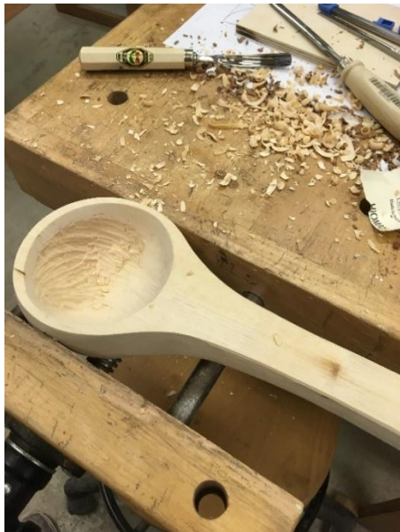
Lihvitud kulbi süvistamine kumerpeitliga
