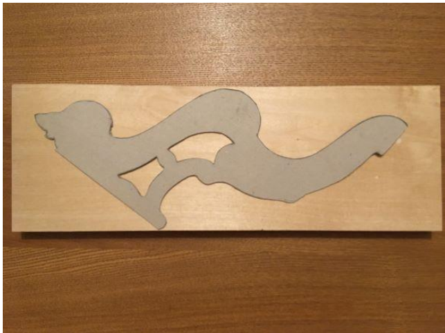
Kasepuidust laud ja šabloon, millest valmib uus ažuurne tugijalg (või selle osa); detaili väljalõikamine lintsael.
