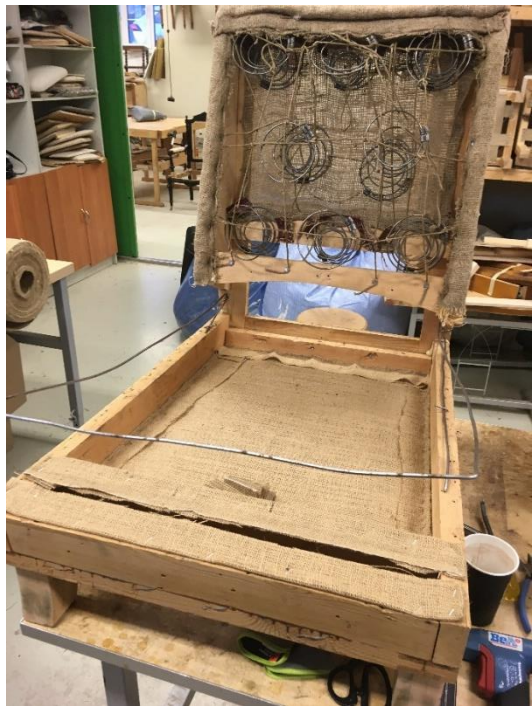
Uue kotiriide paigaldamine põhjale
