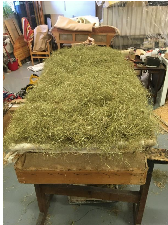
Paigaldasime tagasi vana polstripadja ja sellele värsket meriheina kihi tasanduseks
