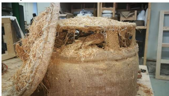
Foto nr 43 – tumba pärast katteriide eemaldamist Vana polster on kavas võtta taaskasutusse
