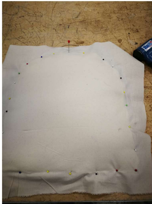
Foto 34 – istmepolstri vaheriide pingutamine
