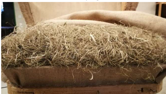
Foto nr 67 - tihiniitidele paigaldatud täidis
