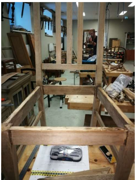
Foto 8 – lahtivõetud ja puhastatud tool
