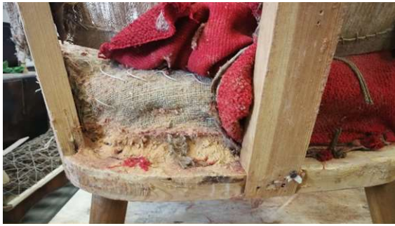
Foto nr 62- katteriide eemaldamine istme- põhjalt
