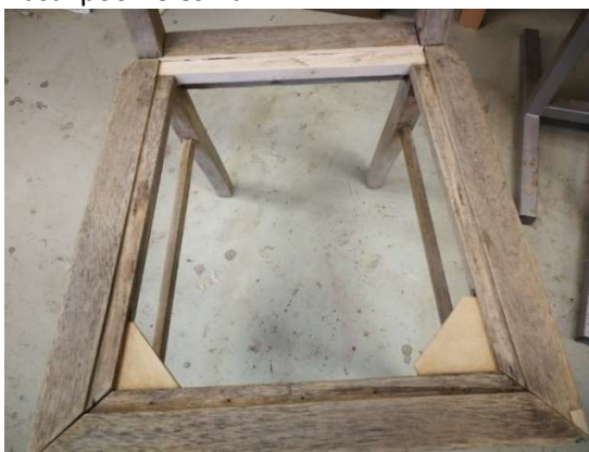
Foto 11 – asendatud tagasari ja plommitud vasakpoolne esinurk
