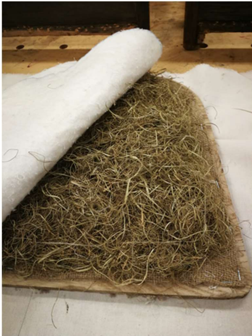
Foto 33- toolipõhjale kõva polstri ehitamine
