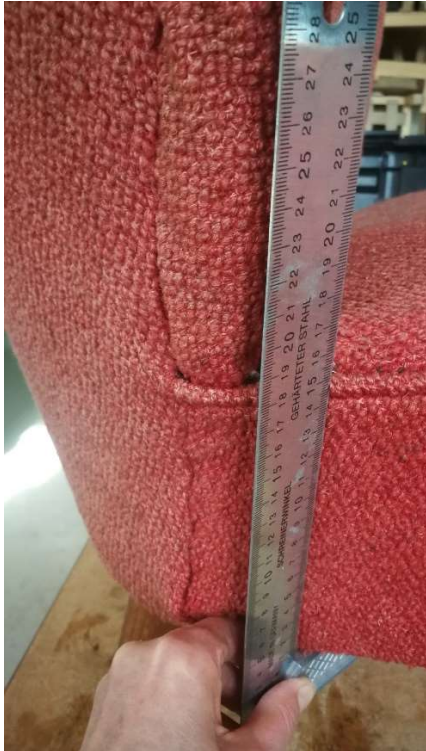
Foto nr 61- tugitooli dokumenteerimine, istmepolstri algse kõrguse määramine
