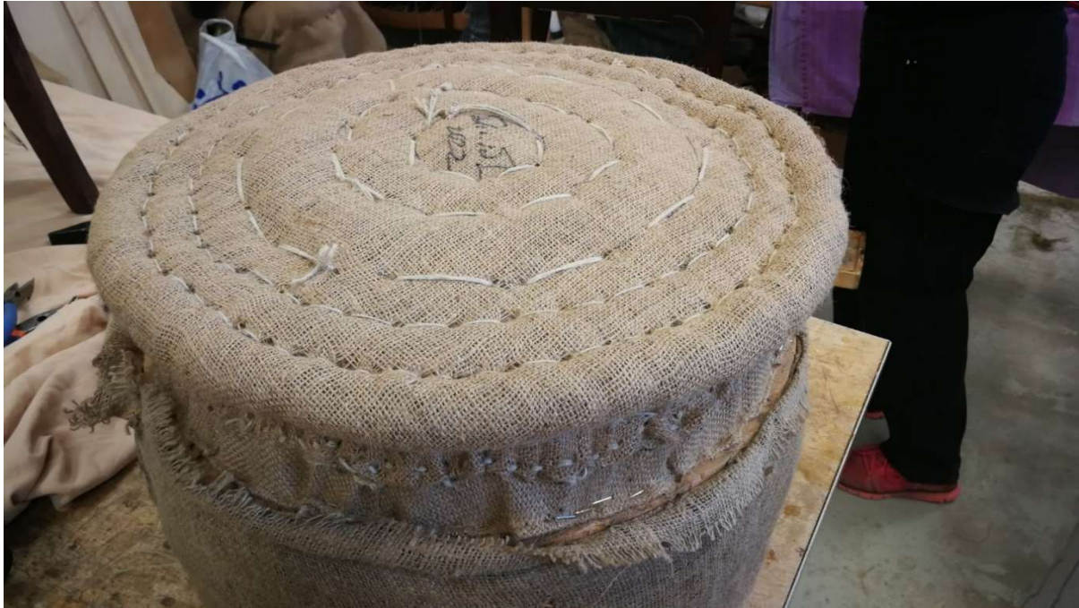
Foto nr 50 – tumba istmeosa kaetud puuvillakangaga Serv täidetud meriheinaga. Pingutusnõelad märgivad kohta, kuhu tuleb serva mitkali ülemine õmblus
