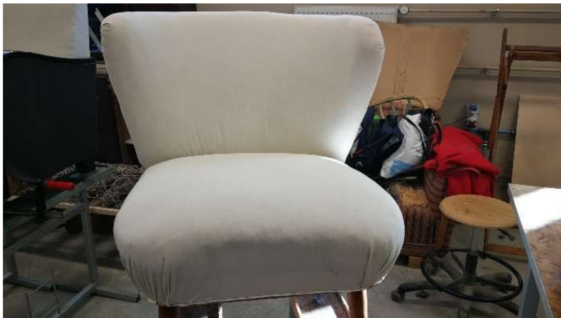
Foto nr 73 – istmepõhi ja seljatoe esikülg on mitkaliga kaetud põ
