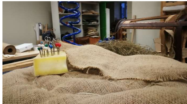
Foto nr 48 – vanale polstrile merihein, kotiriie, keskosa topeltraviknõelaga läbi õmmeldud
