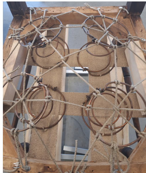
Vedrude sidumine jämeda kanepinööriga. Kinnitasin nööri otsad raamile polstrinaelte ja klambritega.
