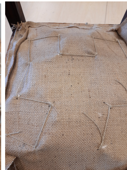
Vedrudele kotiriide kinnitamine ja õmblemine. Peale antud sammu õmblesin tihiniidid, mida piltidel ei ole kuvatud.
