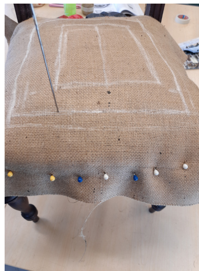
Meriheina kihi katmine kotiriidega, selle ajutine kinnitamine ja pealtpoolt läbi õmblemine. Õmbluste pingutamine istudes toolil, et eemadada liigne õhk.
