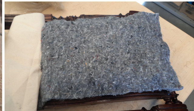
Sarnaselt istme polstrile tegin ka seljatoe polstri. Seljatoe polstril ei kasutanud vedrusid. Samuti kasutasin istme polstiga võrreldes palju õhemat kihti meriheina ja hobujõhvi. Üldine tegemise protsess samasugune.
