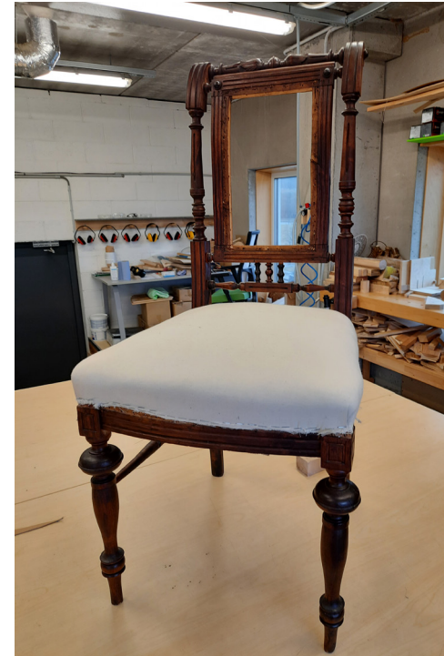
Paigaldas hobujõhvi peale hallivati ja mitkalikihi.
