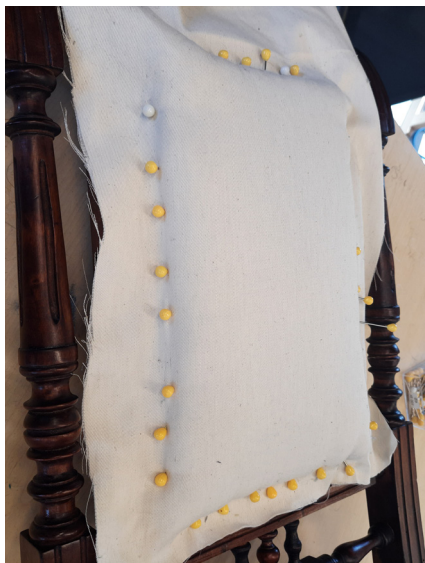
Mitkali kinnitamine seljatoele esialgu nõopnöelte ja seejärel klambritega. Mitkali äärte ära löikamine.
