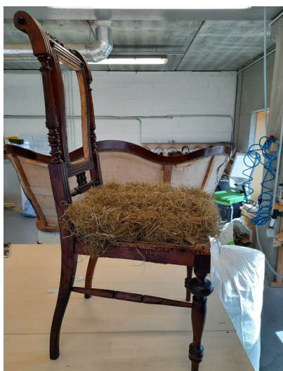
Meriheina paigaldamine tihiniitide alla.
