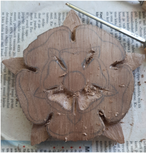
Pähklipuidust Tudori roosi peiteldamise protsess. Lõppviimistlus naturaalse õliga.
