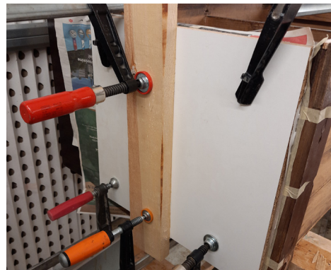
Paigaldas in männi spoonist tasanduskihi ja fikseerisin kuivamise ajaks pressi alla paika.
