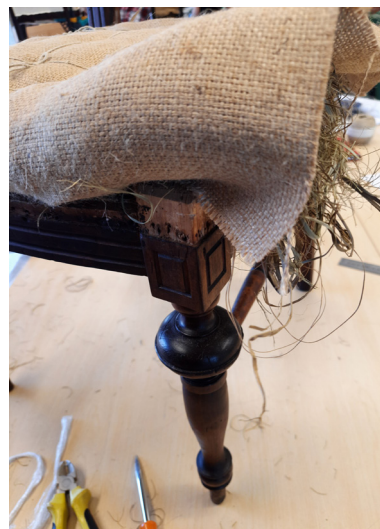
Meriheina vorstikeste lisamisega tooli polstri külgedele kuju andmine. Kotiriide lõpuni kinnitamine.
