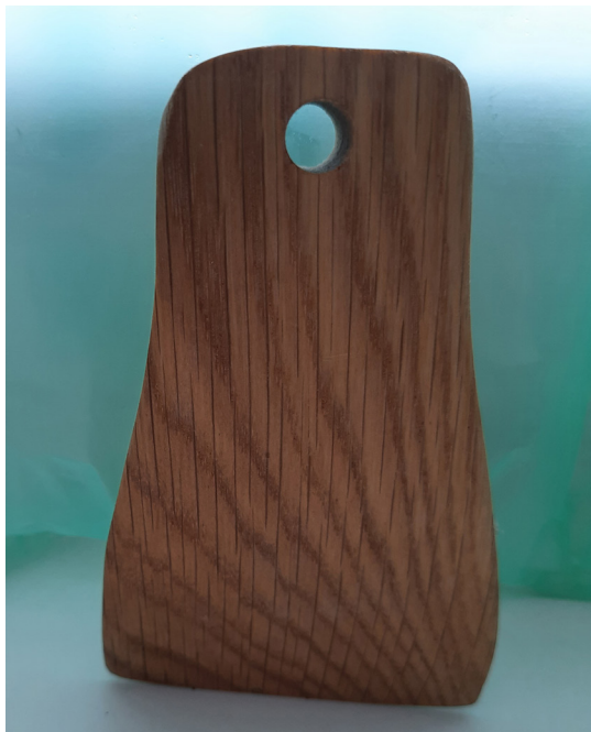
Puidutoorikule joonise järgi välimise kuju andmine lintsaega. Sisemised väljalõiked jõhvsauga.
