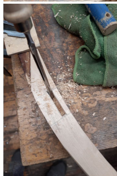
Rekonstrueeritud jalale pulgaaugu puurimine ja keeltappide peiteldamine.
