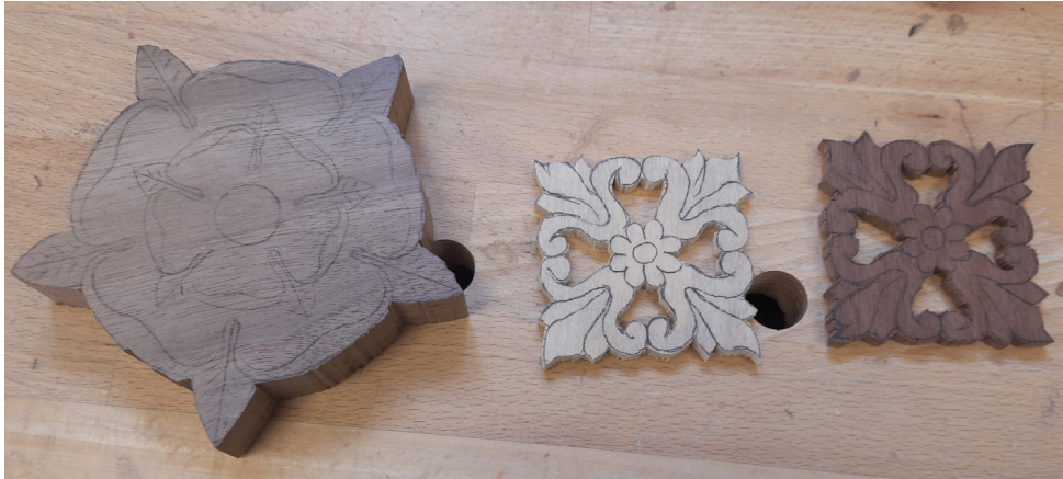
Puidutoorikule joonise järgi välimise kuju andmine lintsaega. Sisemised väljalõiked jõhvsauga.
