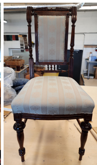
Katteriide juurdelõikus ja seejärel paigaldus istme ja seljatoe polstrile. Kinnitatud klambritega. Katteriide äärde ilupaela liimimine tekstiililiimiga.
