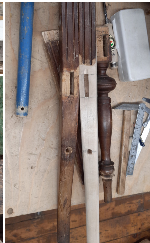
Rekonstrueeritud jalale pulgaaugu puurimine ja keeltappide peiteldamine.
