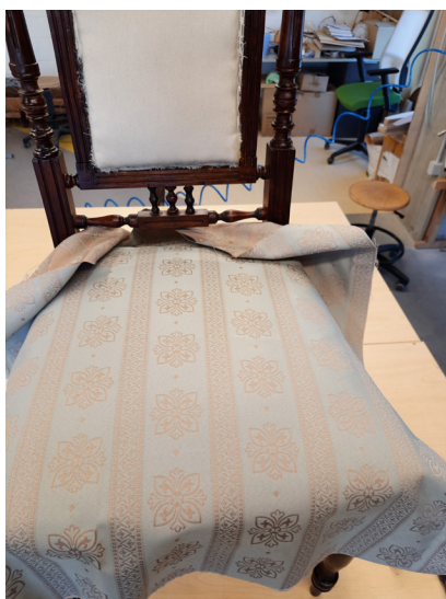
Katteriide juurdelõikus ja seejärel paigaldus istme ja seljatoe polstrile. Kinnitatud klambritega. Katteriide äärde ilupaela liimimine tekstiililiimiga.
