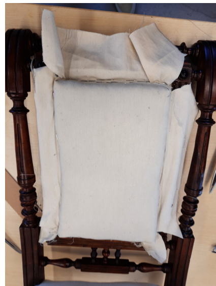
Mitkali kinnitamine seljatoele esialgu nõopnöelte ja seejärel klambritega. Mitkali äärte ära löikamine.
