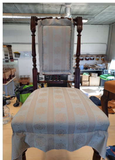
Katteriide juurdelõikus ja seejärel paigaldus istme ja seljatoe polstrile. Kinnitatud klambritega. Katteriide äärde ilupaela liimimine tekstiililiimiga.
