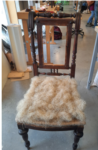
Tihiniitide alla paigaldatud hobujõhv.
