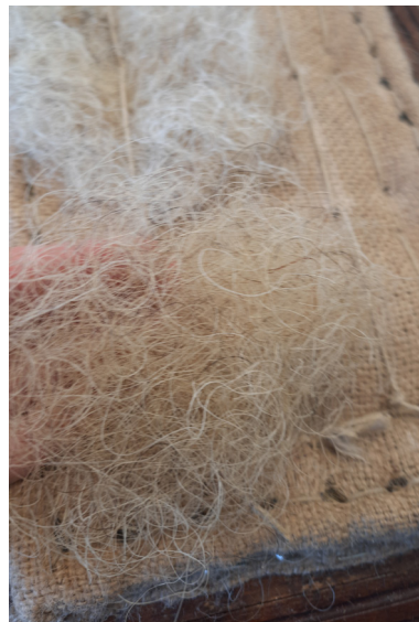
Sarnaselt istme polstrile tegin ka seljatoe polstri. Seljatoe polstril ei kasutanud vedrusid. Samuti kasutasin istme polstiga võrreldes palju õhemat kihti meriheina ja hobujõhvi. Üldine tegemise protsess samasugune.
