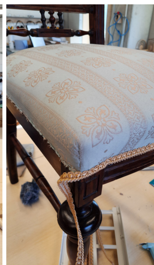
Katteriide juurdelõikus ja seejärel paigaldus istme ja seljatoe polstrile. Kinnitatud klambritega. Katteriide äärde ilupaela liimimine tekstiililiimiga.
