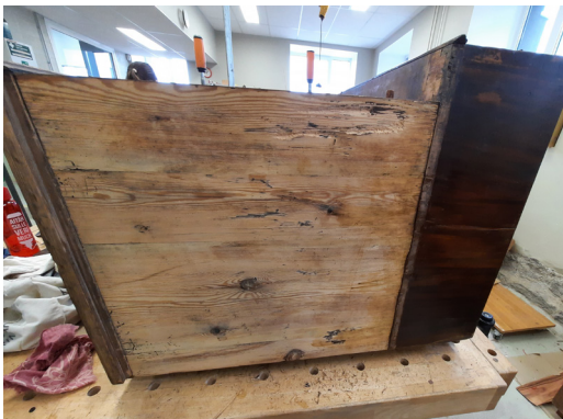
Pesukummuti külg enne spooni paigaldamist.
