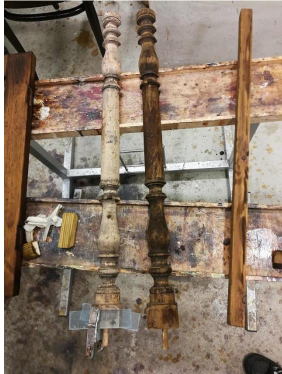
Pilt 12 Kapi ja detailide peitsimine
