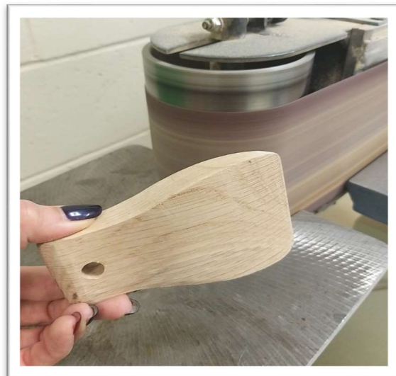
Spoonimisklotsi lihvimine lintlihvijal.
