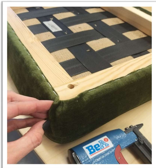
Põhja ja nurkade klammerdamine.
