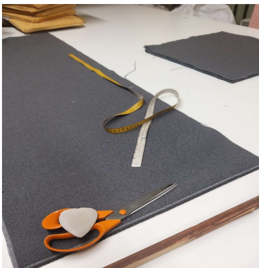
Mõõtsin ja lõikasin neile uued kangad. Liimisin uue porolooni.
