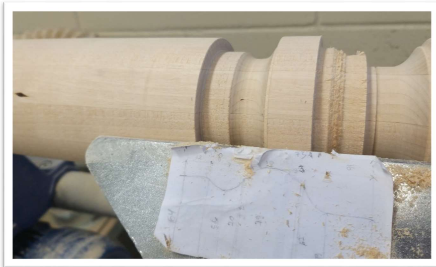
Joonise järgi treimine.
