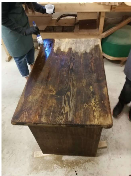
Kapi ja detailide peitsimine vee baasil peitsiga, tooniks on hele pähkel. Peale kuivamist kruntimine.
