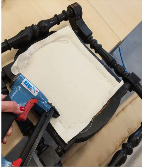
Leeni taguse klammerdamine ja lõigatud mitkal.
