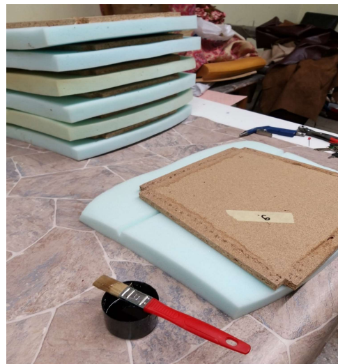
Mõõtsin ja lõikasin neile uued kangad. Liimisin uue porolooni.
