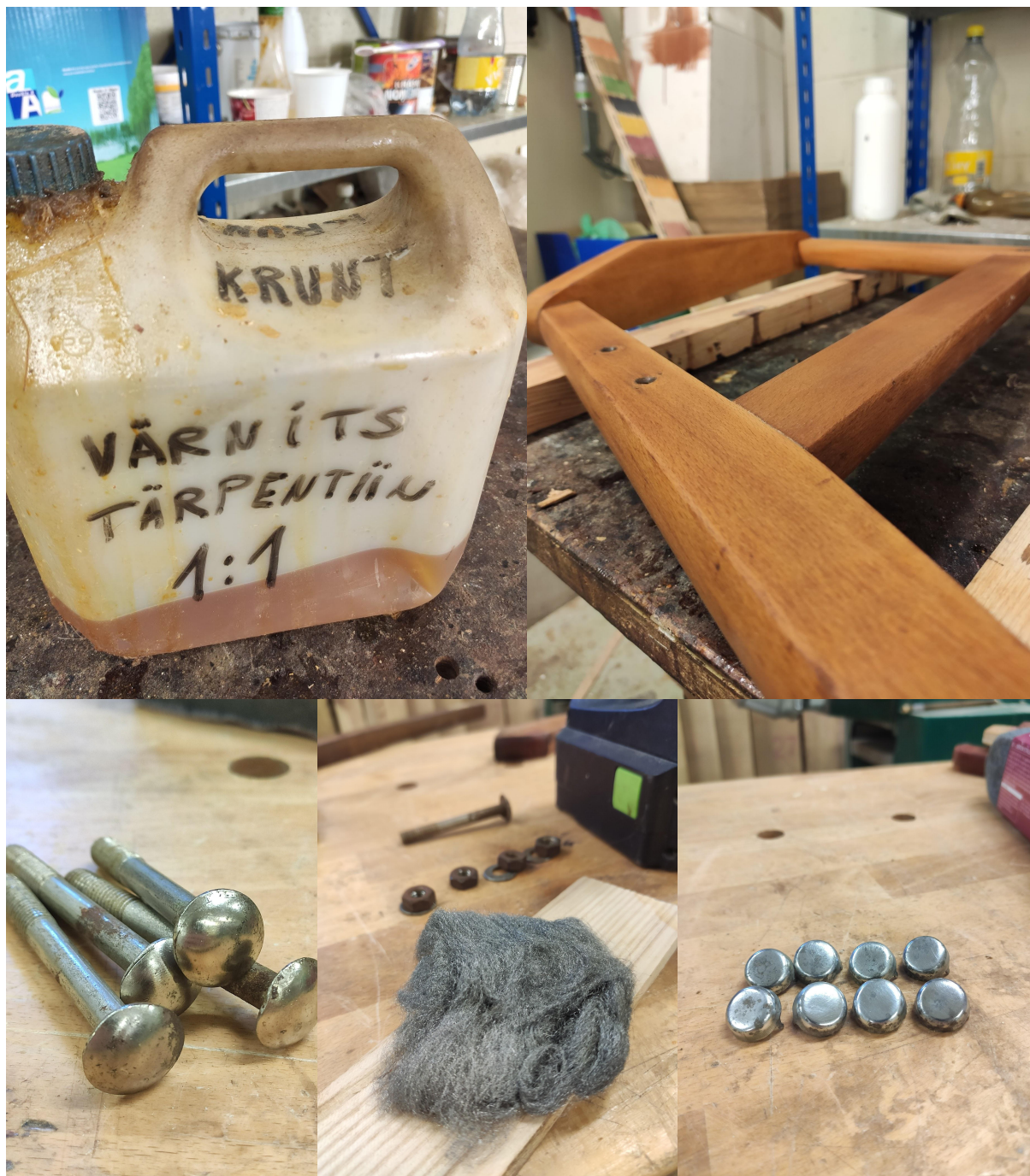
Jalaraamid on kokku liimitud, üle lihvitud, puhtad ja kaetud krundiga. Poldid ja kruvide katted on puhastatud ja poleeritud terasvillaga.
