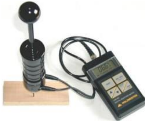
Joonis 41. Elektrilise takistuse põhimõttel töötav niiskuse mõõtja.
